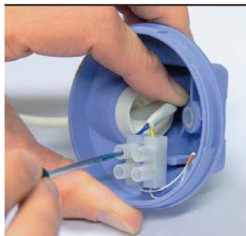
Figur 17: Utegivare med termistor
