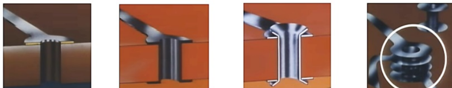
Figur 13: Olika förstärkningar från höger till vänster är normalt hål, dubbelt kort med pläterade hål, funnelet förstärkning gjord av koppar, inre kopplingar vilket återfinns i kretskort med flera lager där komponent kan hålmonteras
