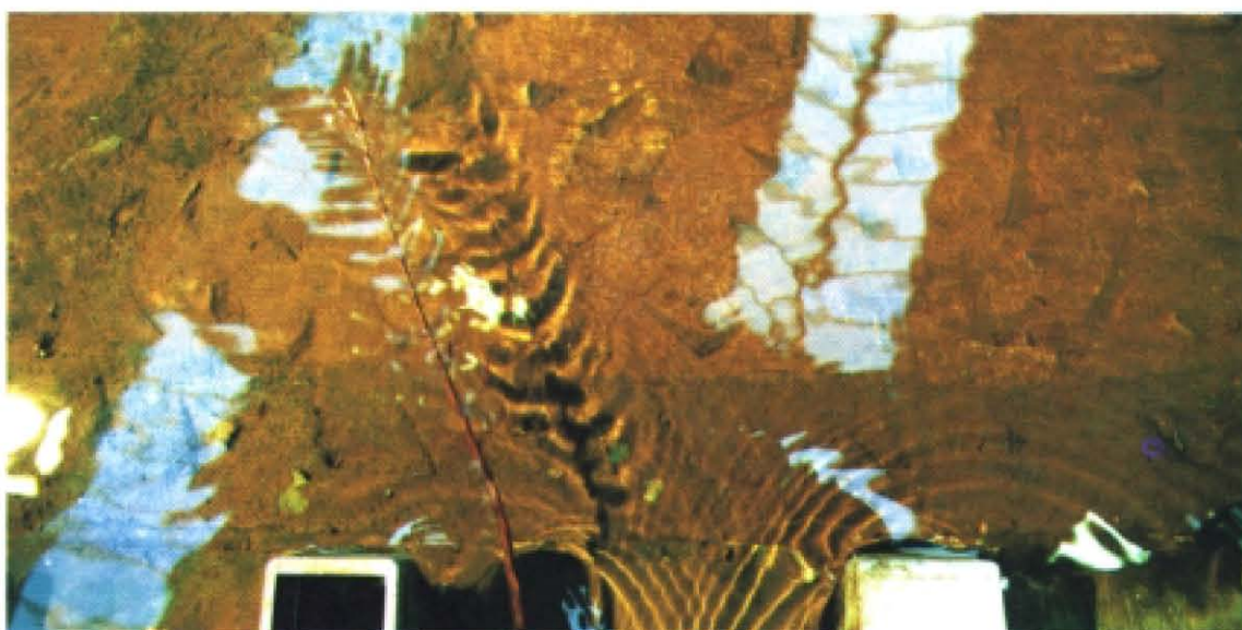
Bild 2a, b och c. Drivgoods uppträdande i solitärt utskov. Ett träd framför pelaren dras av vattenströmmen mot utskovet och passerar.
