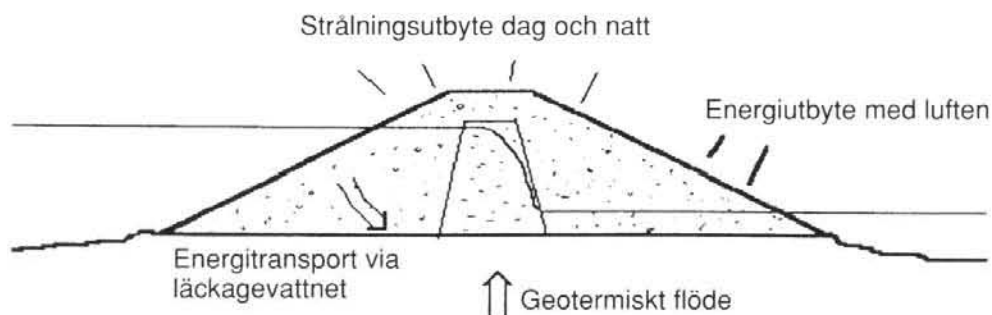
Figur 19. Energiflödet i en fyllningsdamm.
