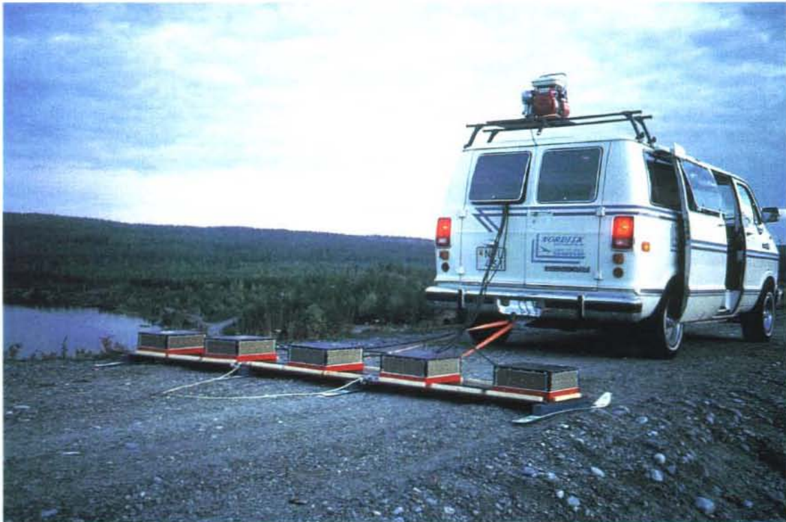
Figur 13. Georadarmätning med fem antenner för lokalisering av tät kärnans krön.
