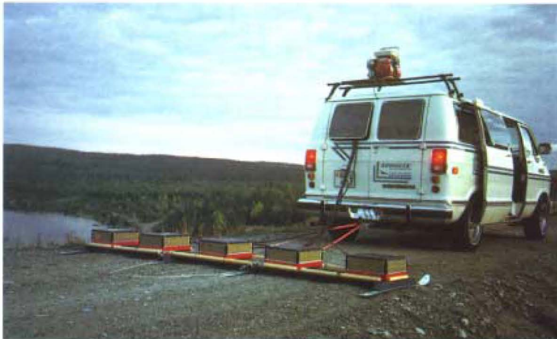
Figur 7.2. Georadarmätning med fem antenner för lokalisering av tätjärnans krön.
