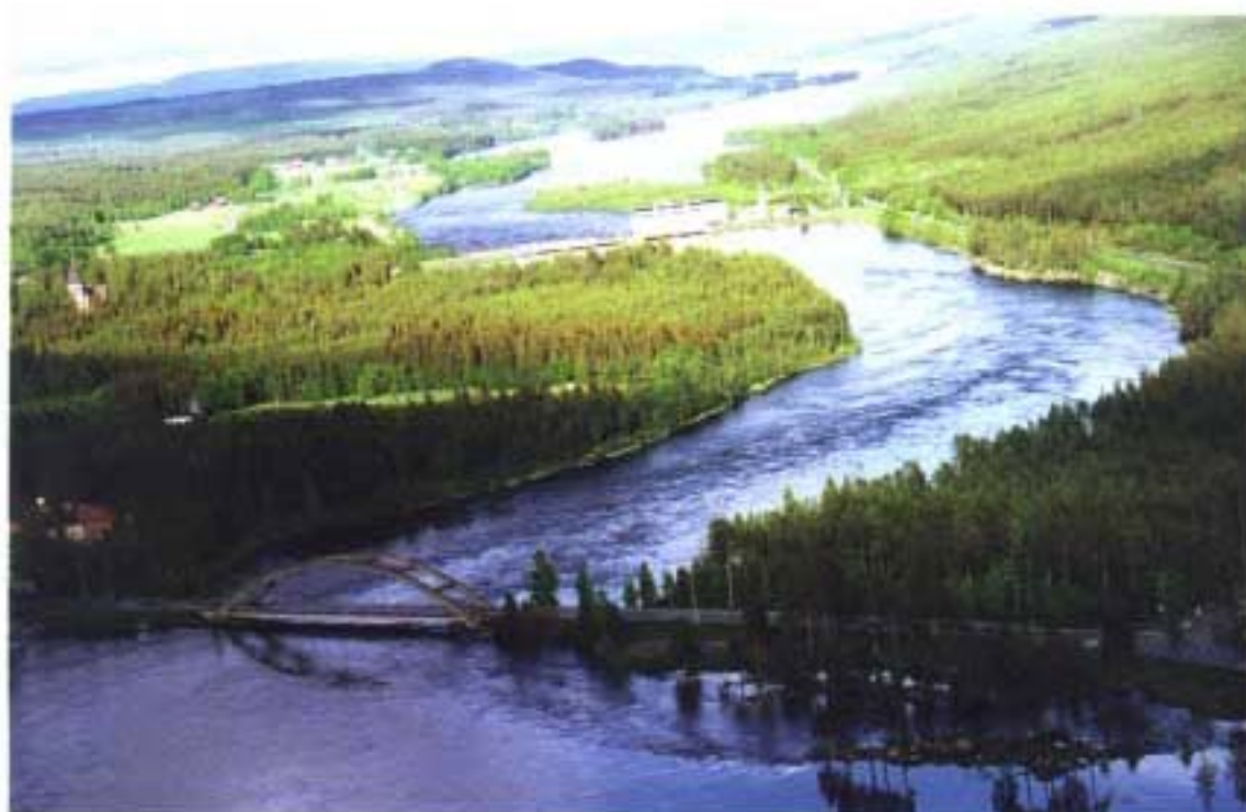
Figur 3.4. Bilden visar fallförluster uppströms Stuguns kraftverk vid högt flöde. Förluster finns både vid bron och längre uppströms (nedtill i bild).
