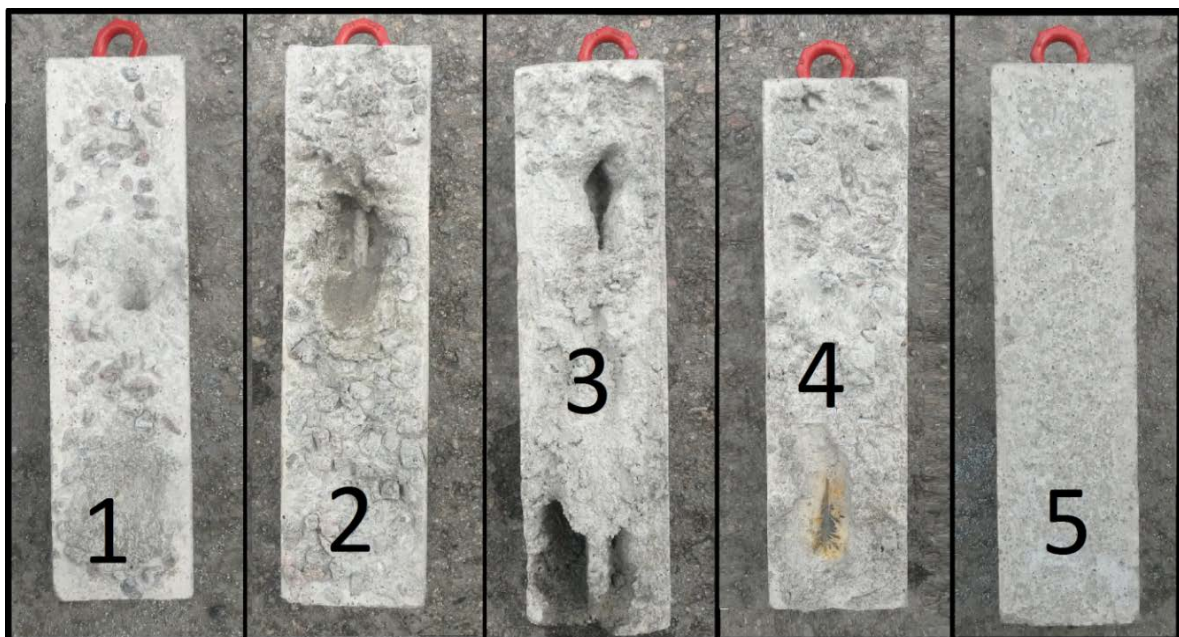
Figur 7.17 De fem gjutna balkarna och dess tillverkade skador.
