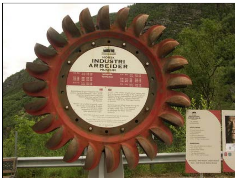
Figur 2.12 Peltoneturbin, massivt nav med skålar längs med ytterkanten (Kuhlin 2015c).
