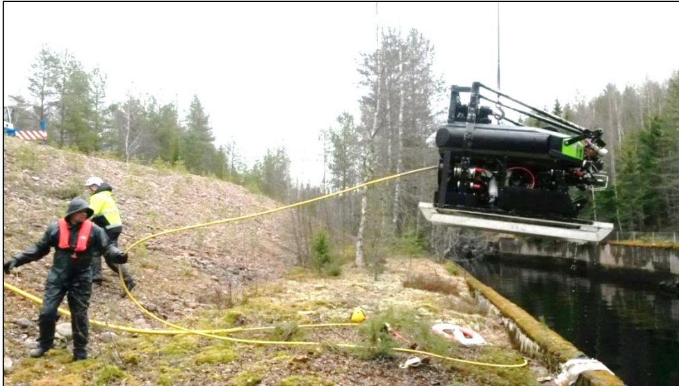
Figur 7.15 ROV sjösätts med kran.
