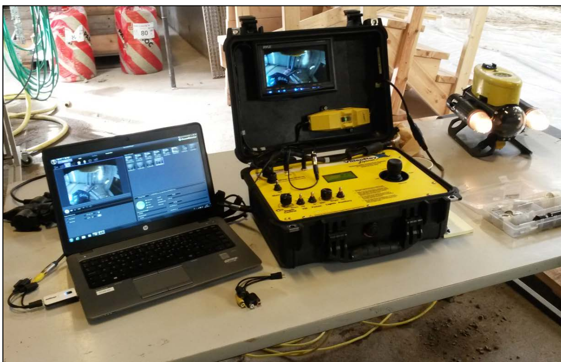
Figur 7.19 Styrsystem med inkopplad dator, t.h. står ROV:en.
