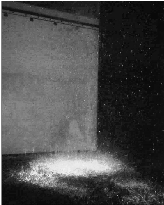
Figur 7.8 Inläckage av vatten i sugrörets tak.
