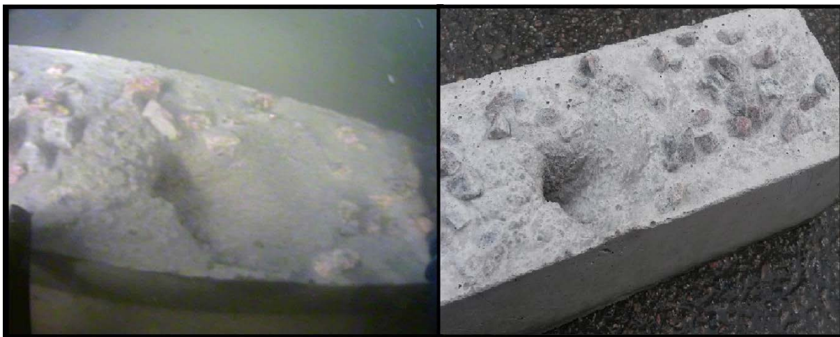
Figur 7.24 Balk 1 med tillverkade erosionsskada. T.v. foto från ROV och t.h. foto från torrhet.
