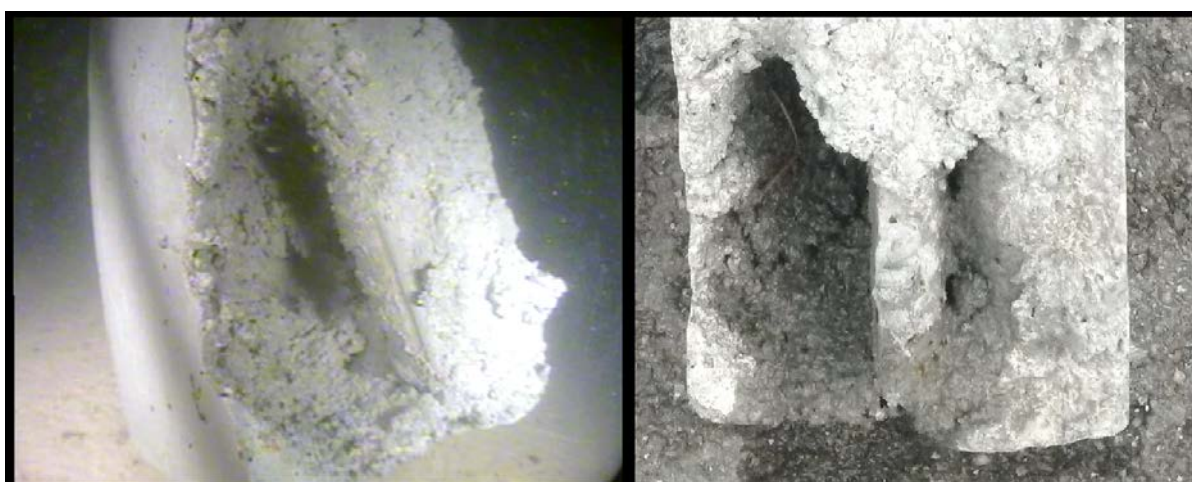
Figur 7.26 Balk 3 med tillverkad erosionsskada och ett armeringsjärn. T.v. foto från ROV och t.h. foto från torrhet.
