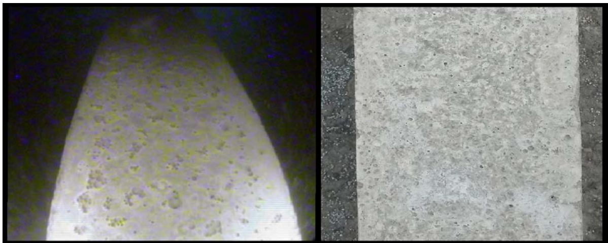
Figur 7.28 Balk 5 utan några tillverkade skador. T.v. foto från ROV och t.h. foto från torrhet.
