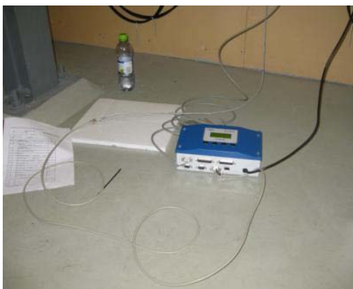
Figur 4.4 Data från anläggningen lagras i en datalogger, SBC+.
