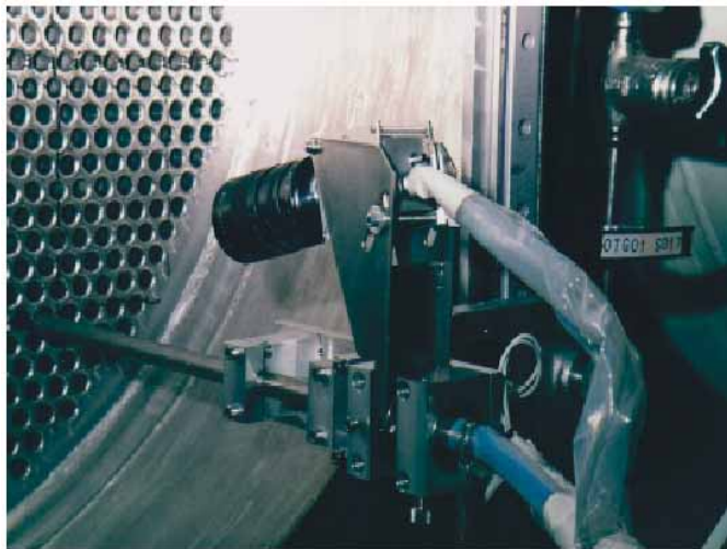
Figur 1.6-8 Utrustning för kontroll av godstjocklek hos tuber i värmväxlare till vänster och resultatredovisning till höger där olika färger motsvarar olika intervall av godstjockleksreduktion.
