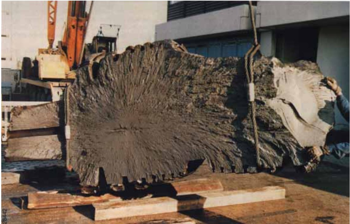
Figur 2.3.1-1b) Ångturbiner: haveri av en enblockshögtrycksrotor till följd av utmattningsbrott som uppkommit på grund av ett tillverkningsfel i centrum av rotorn.
