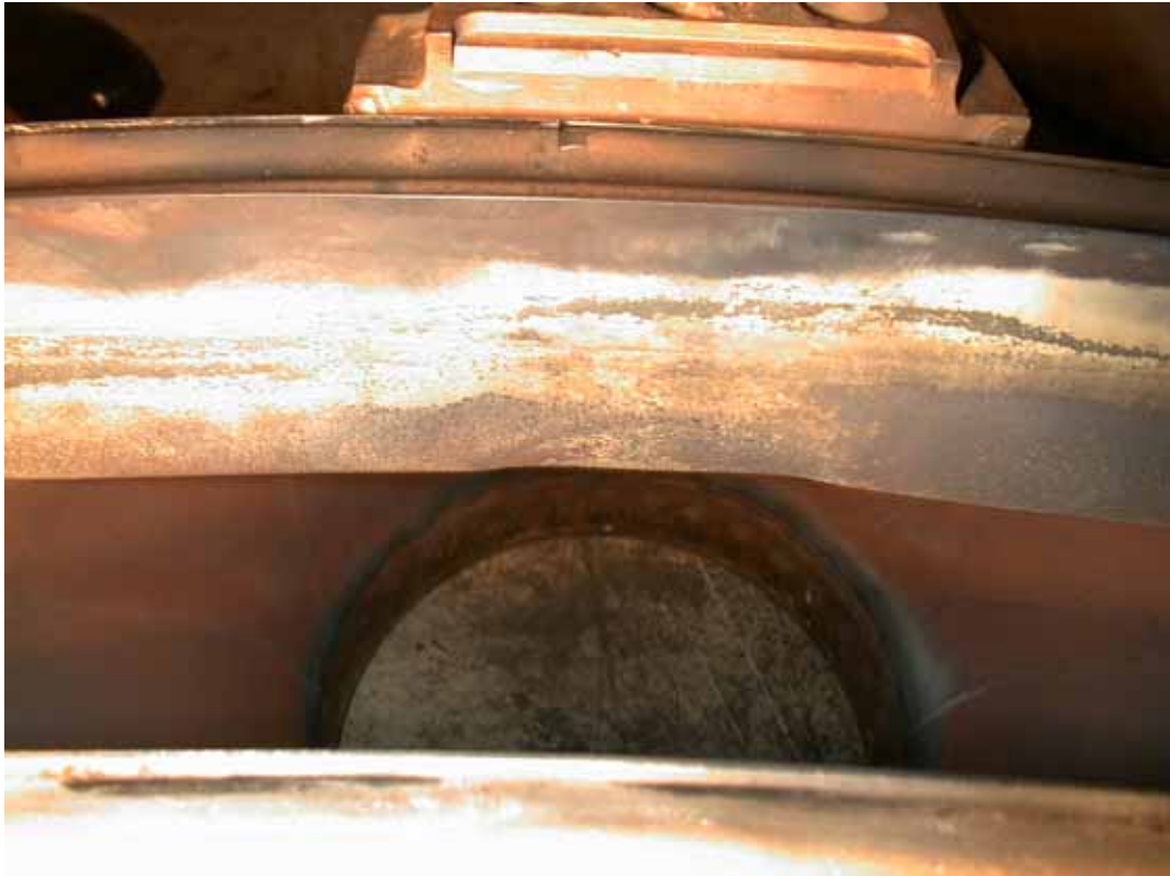
Figur 2.3.2-3. Ytoxideration på ett mellanstycke.
