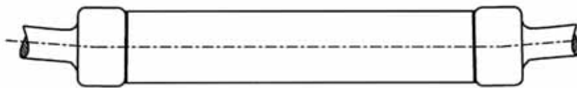
Figur 2.3.3-9. Böjning av rotoraxeln.
