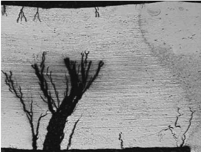
Figur 1.5-22. Spänningskorrosion i ett tvärsnitt av en komponent av austenitiskt rostfritt stål SS-stål 2343. Till höger i bild syns en smältgräns samt svetsgods [DNV AB].
