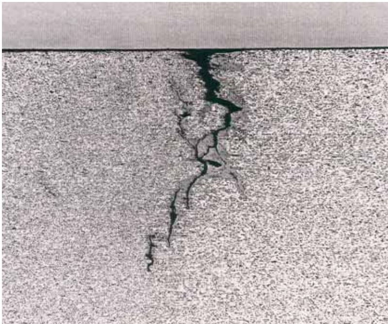
Figur 2.4-5. Metallografiskt tvärsnitt av tvärsprickan i rundsvetsen.
