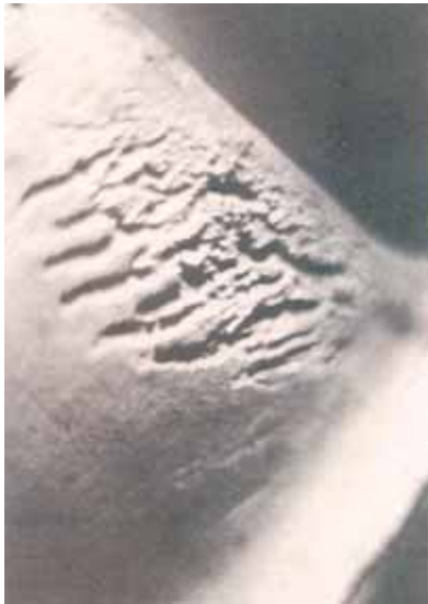
Figur 2.4-14 Kavitationsskada på ett propellerblad.
