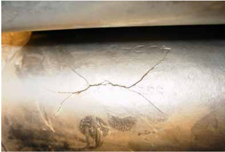
Figur 1.5-21. Spänningskorrosionssprickor i en tub av austenitiskt rostfritt stål SS-stål 2343 [DNV AB].
