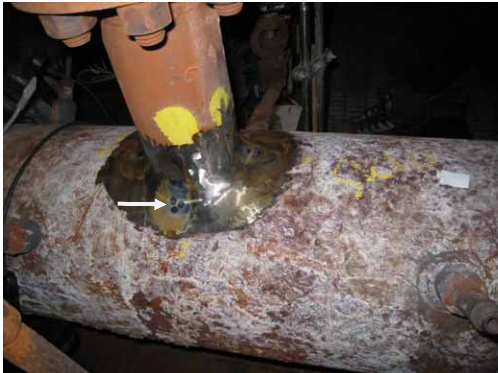
Figur 1.6-10. Metallografisk provpreparering för replikprovning av en stutsvets.
