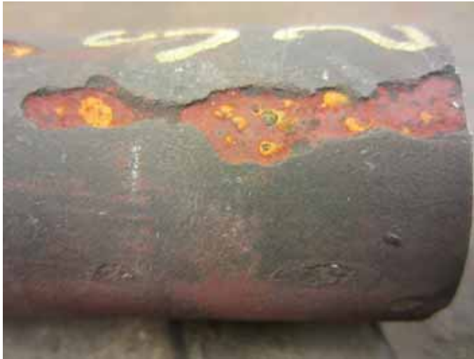
Figur 1.5-25. Överhettartub som har utsatts för saltsmältakorrosion.
