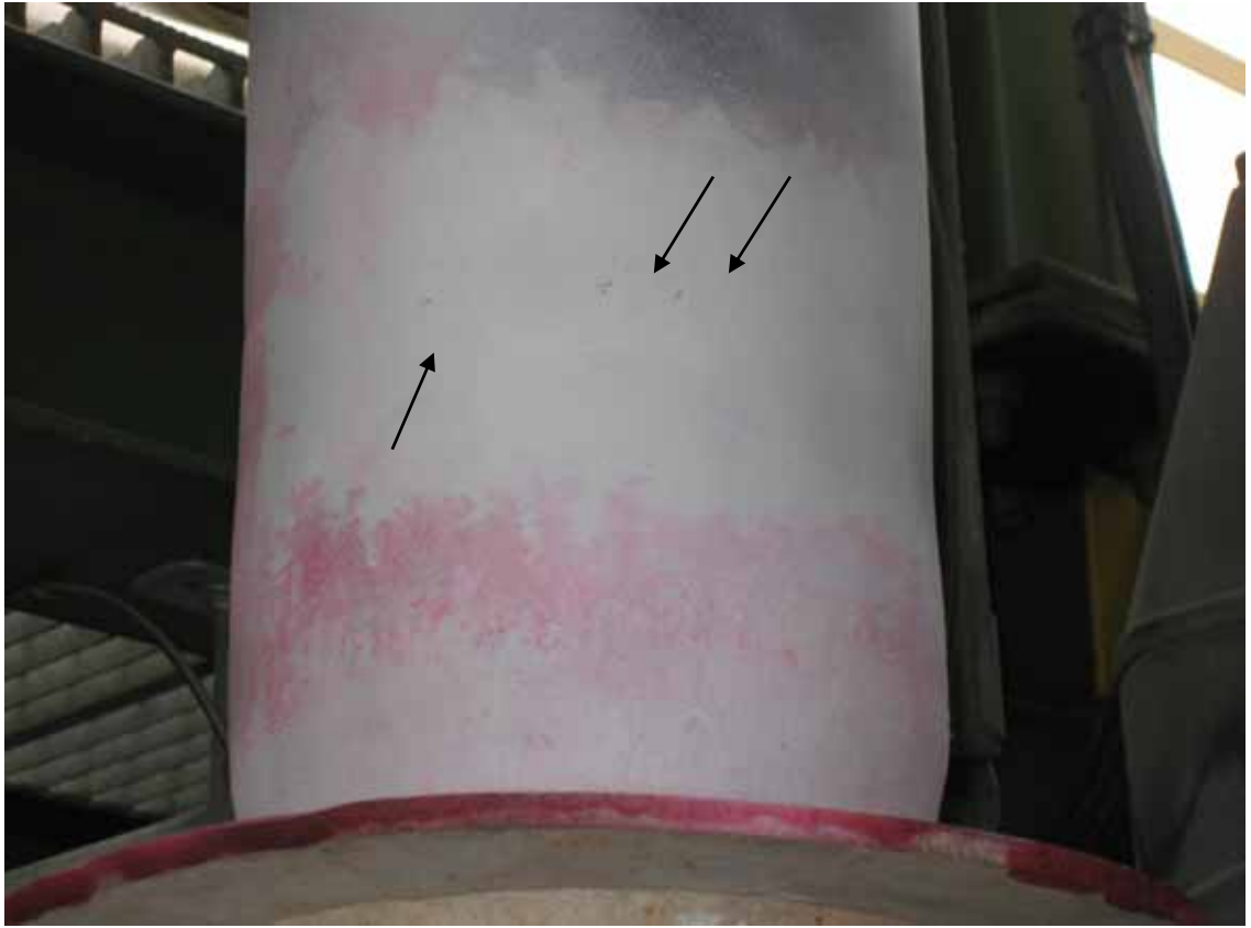
Figur 1.6-5. Små indikationer vid svets, påvisade med PT.
