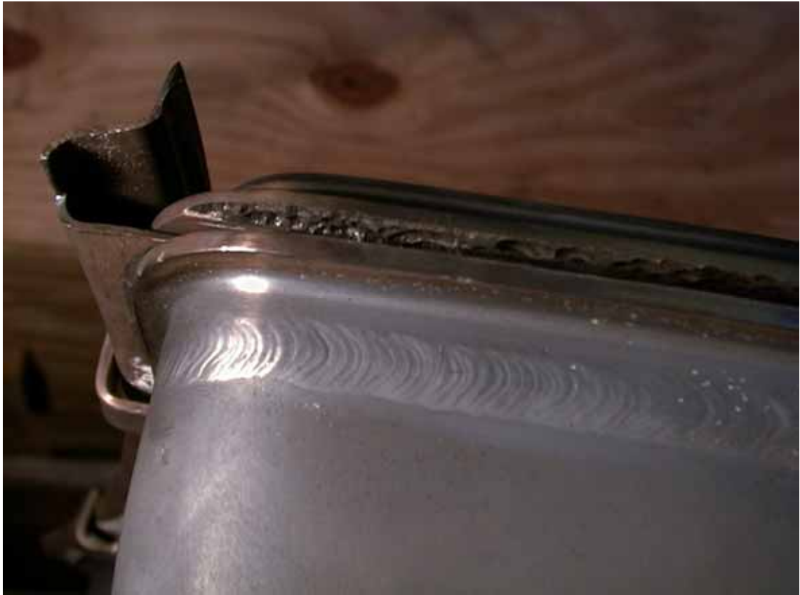
Figur 2.3.2-2. Nötning av bakre tätning på ett mellanstycke..
