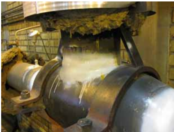
Figur 1.5–12. Krysprickor i ett T-stycke i ett svenskt kraftvärmeverk.
