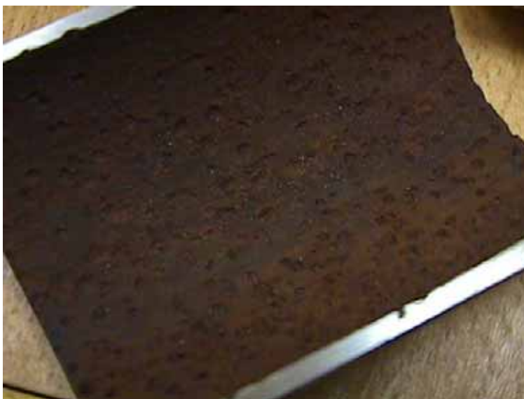
Figur 1.5-19. Gropfrätning till följd av medbrytning av magnetitskikt [DNV AB].
