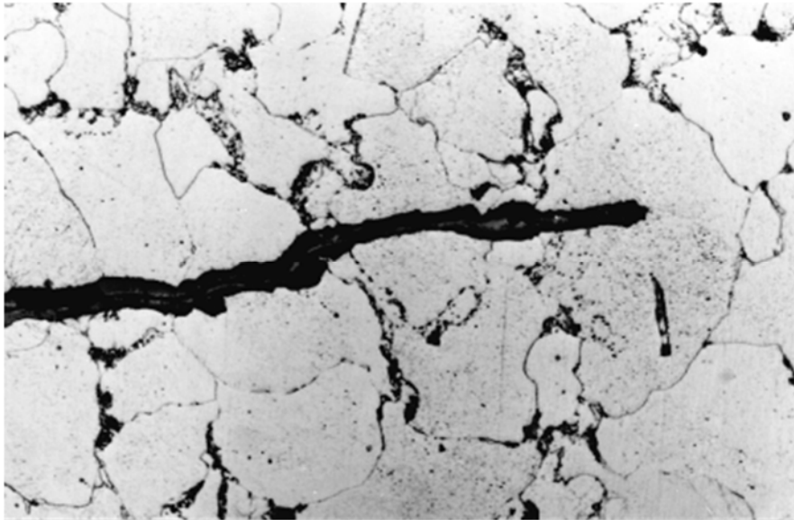
Figur 1.5-4 . LCF-spricka i ett 0.5Cr0.5Mo0.25V stål provat vid 550°C, 1000x förstoring.
