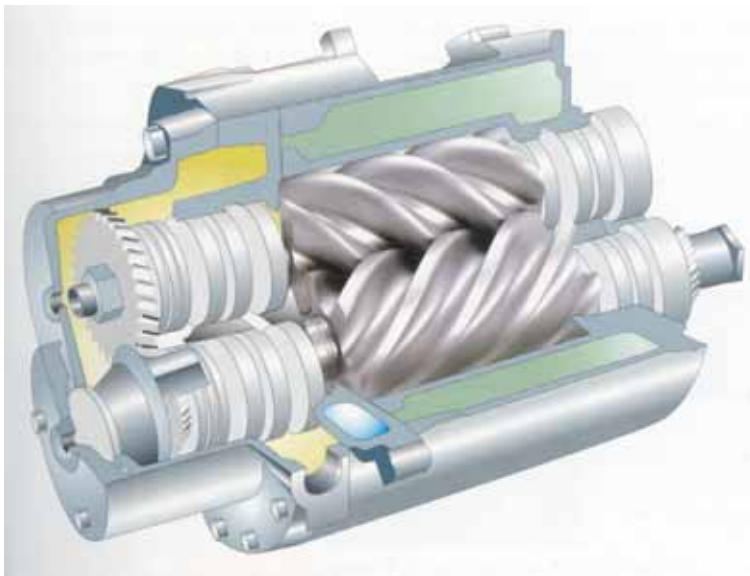
Figur 2.5-17. Ett steg i en oljefri kompressor. Skruv och slid ligger lagrade i rotorhuset som är vattenkyld.
