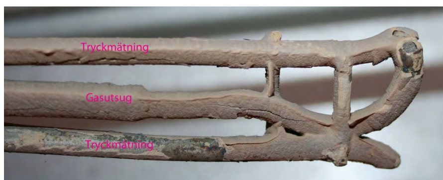
Figur 4 Foto av spetsen av partikelutsugssonden. De två yttre rören används för differenstryckmätning och det mellersta röret är själva gasutsuget.
