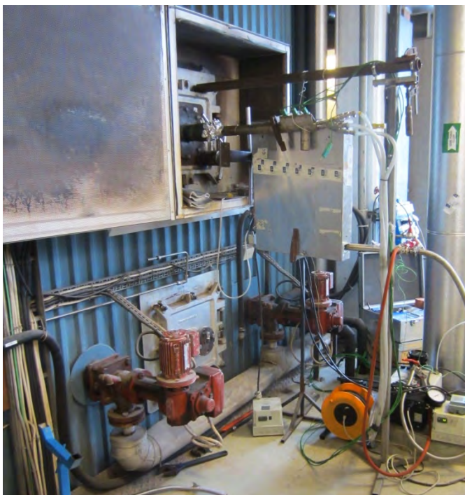
Figur 14 Foto från mätposition vid Chalmers under provtagning av både beläggningar och partiklar. Impaktorn är här innesluten i en uppvärmd metallåda för att säkerställa en jämn temperatur.
