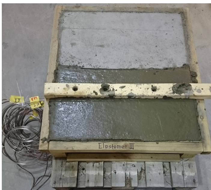
Fig. 3.16. Fogbandsprovkropp innehållande nio termoelement efter avslutad gjutning.
