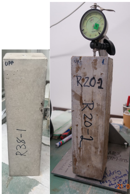
Fig. 3.25. Provkropp innan exponering samt provkropp installerad i mätuppställningen.
