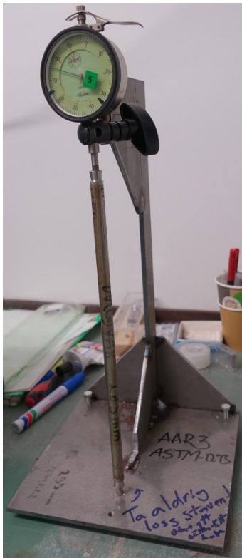
Fig. 3.24. Mätuppställning av betongprismor baserad på specifikationer enligt RILEM AAR-3 och ASTM-C1293. Samtliga mätningar gjorde i relation till en Invar stång med längden 284.97 mm. Invar är en metall legering med mycket god temperaturstabilitet.
