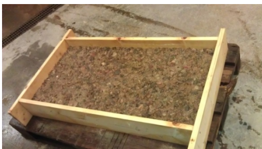
Fig. 3.1 Provkropp i gjutform innan pågjutning
