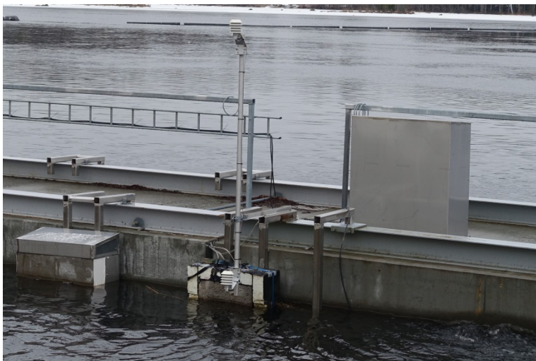
Fig. 2.4 Uppställning för temperaturmätning vid fältstationen.
