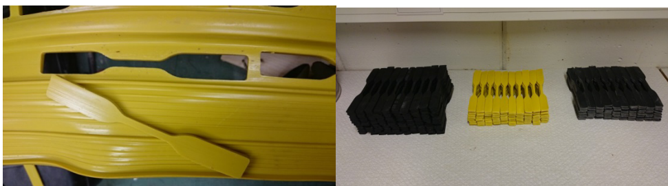
Fig. 3.21. Exempel på utstansat hundben (t.v.), samtliga 3*90 hundben utstansade för analys (t.h.)
