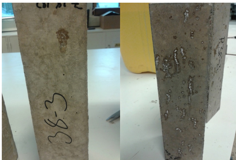
Fig. 3.36. Iakttagelser i och med mätningar efter 91 dygn för provkropparna exponerade för 38 °C. Vid provningstillfället observerades fler utfällningar (t.h.) på provkropp med reaktiv ballast, bara någon enstaka fläck (t.v.) observerades på provkropp med icke reaktiv ballast.
