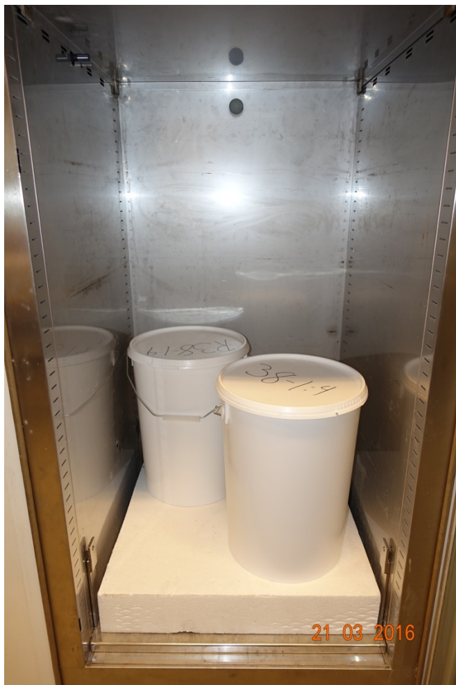
Fig. 3.27. Exponering av R38-1:4 och 38-1:4 i enlighet med RILEM AAR-3 samt ASTM C1293. Vardera hinken innehöll fyra provkroppar och hinkarna var placerade i ett klimatskåp som höll 38 °C.
