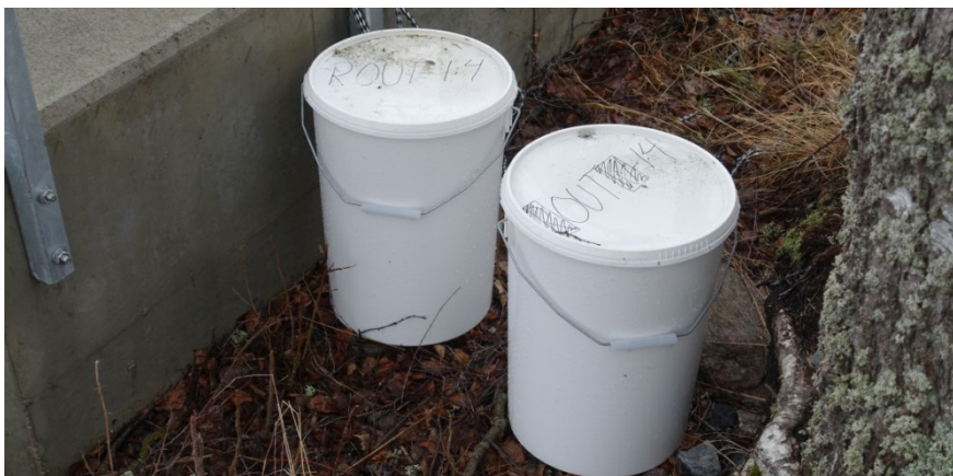
Fig. 3.30. Exponering av provkroppar OUT-1:4 samt ROUT-1:4. Provkropparna förvarades det första året inomhus i förslutna hinkar med vattenspiegel i klimatrums som höll 20 °C och efter ett år flyttades dem ut till fältstationen. Hinkarna placerades så att direkt solljus begränsades.
