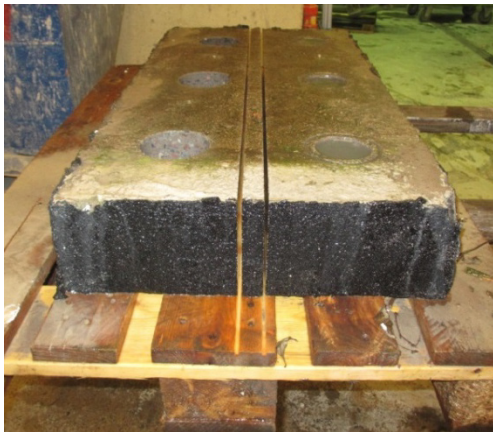
Fig. 3.10. Provkropp 1 från pågjutningsförsöket vid fältstationen efter ett års exponering.
