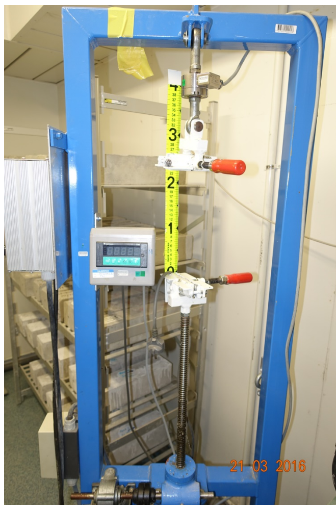
Fig. 3.23. Utrustning för Draghållfasthet och brottöjning enligt VU-SC:19.
