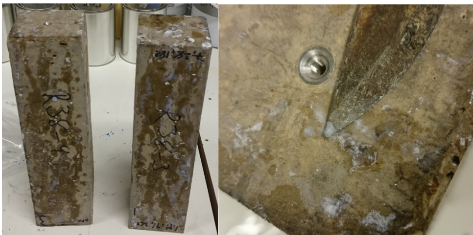
Fig. 3.37 Provkroppar innehållande reaktiv ballast efter ett års exponering i 38°C. Två av provkropparna med tydlig utfällning t.v. och in zoomad gel på knivsudd t.h.
