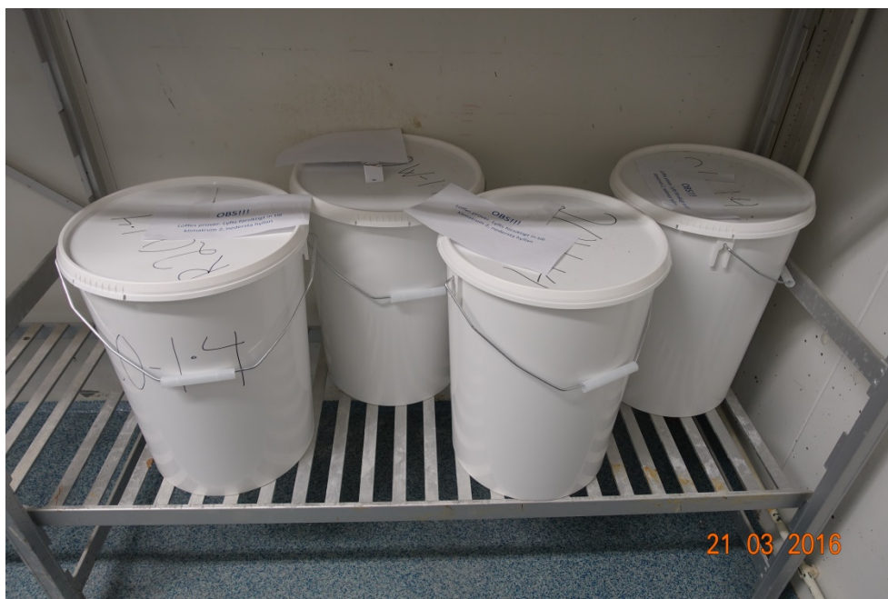
Fig. 3.28. Exponering av R20-1:4, 20-1:4, 20W-1:4, R20W-1:4. I vardera hinken placerades fyra provkroppar och hinkarna var samtliga placerade i klimatrums vilket höll 20 °C 65 %RF. Provkropparna med benämning innehållande ett W exponeras i vatten efter ett år och övriga i en hink på ett galler över en vattenspegel.
