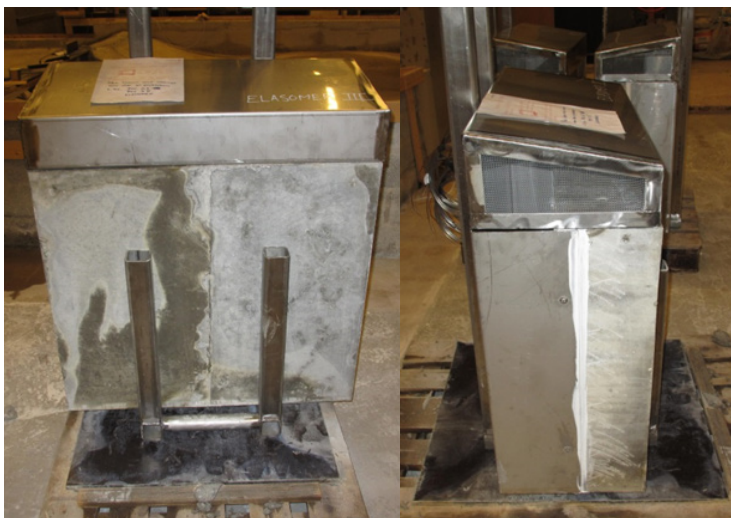
Fig. 3.17. Färdigmonterad provkropp monterad i plåtlåda. I figuren är provkroppen monterad i fästeanordningen för montering på fältstationen.
