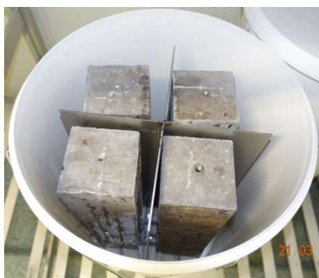
Fig. 3.26. Fyra provkroppar placerade på galler i hink i enlighet med uppställningen vid provning. Under exponering är hinken försedd med lock.
