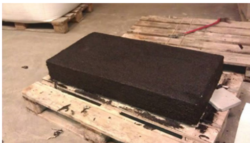
Fig. 3.3. Provkropp med tätmassan
