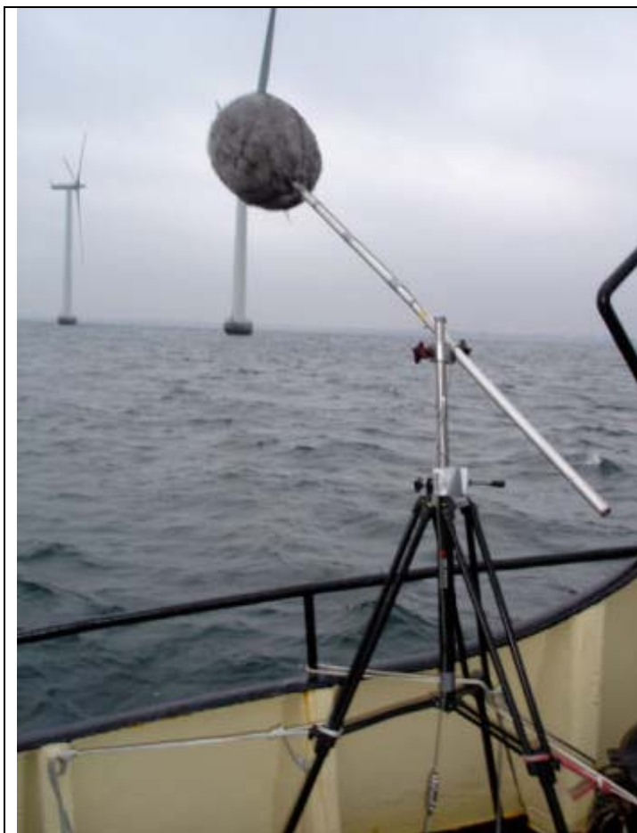
Figur 9 (från [23]) Fotografiet visar mikrofonuppställning vid ett försök att mäta ljudemissionen till havs.
