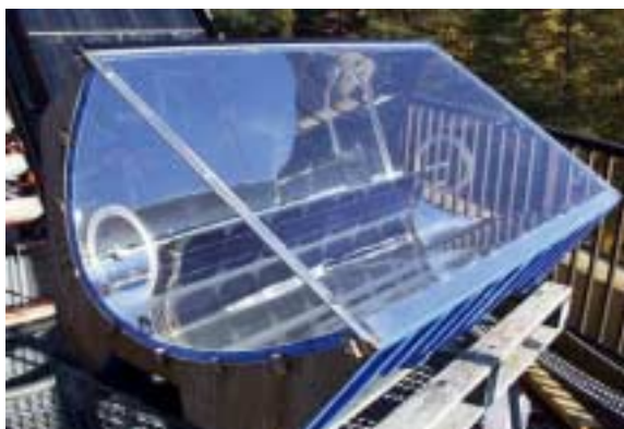
Figur 5: Kort prototyp av solel-solvärmehybrid-MaReCo som utvärderas i Älvkarleby.
