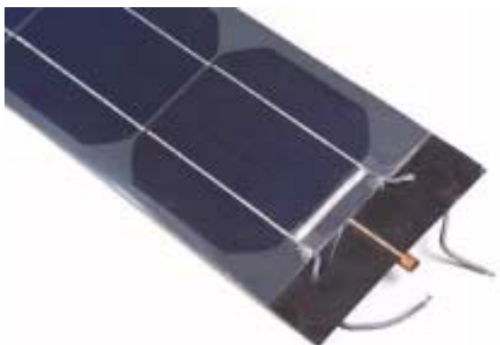
Figur 3: Solel-solvärmehybridmodul som består av enkristallina kiselceller laminerade på en solfångarabsorbator. Kylvatten cirkulerar på i ett kopparrör på baksidan av absorbatorn.
