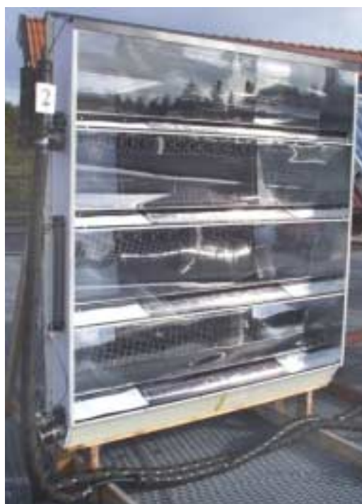
Figur 4: Koncentrerande, vattenkyld solel-solvärmehybridssystem för fasadintegrering. Systemet inkluderar stationära paraboliska aluminiumreflektorer med geometrisk koncentrationsfaktor 3, hybridmoduler och EPS-isolering.
