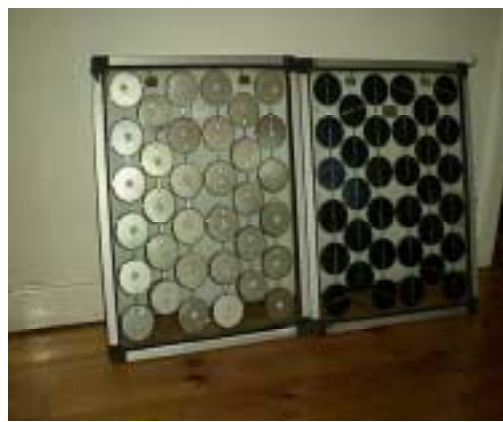
Figur 5.13. Två moduler av fabrikat Philips. Framsidan (höger) och baksidan (vänster). Det framgår av bilden att den spaciösa fördelningen av celler leder till ett stort ljusgenomsläpp mellan cellerna.
