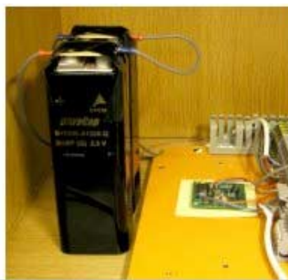
Figur 9.8. De två seriekopplade superkondensatorerna med kapacitansen 3600 Farad ger ett maximalt energiinnehåll om 2,65 Wh per enhet vid maxspänningen 2,3V. Storlek 61x61x170 mm.
