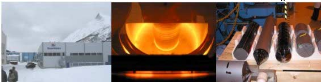
Figur 4.3. a) Scanwafers fabrik i Nordnorge, b) En kiselrodd under tillväxt, c) färdiga kiselroddar.
