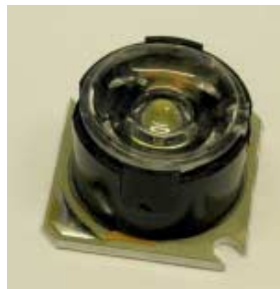
Figur 2.4 Lysdiod av typen Luxeon Star med optik. Diameter 21,5 mm.
