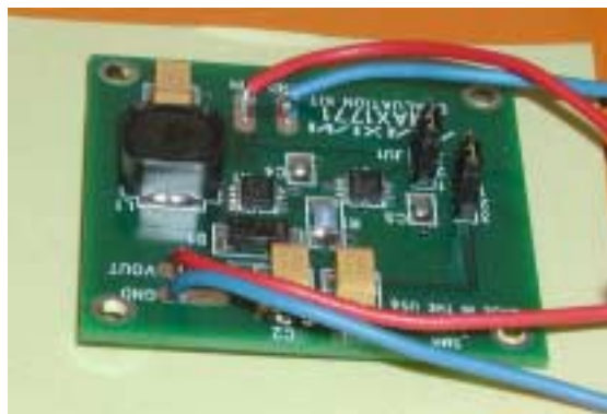
Figur 2.3 Utvecklingskort för regulatorn MAX1771. Mått 54 x 54 mm.
