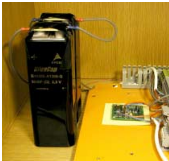
Figur 2.1 De två seriekopplade superkondensatorerna med kapacitansen 3600 Farad.
