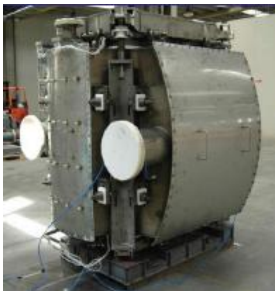
Fig. 5 Ansaldo Fuel Cells nya stack på 200 kW
