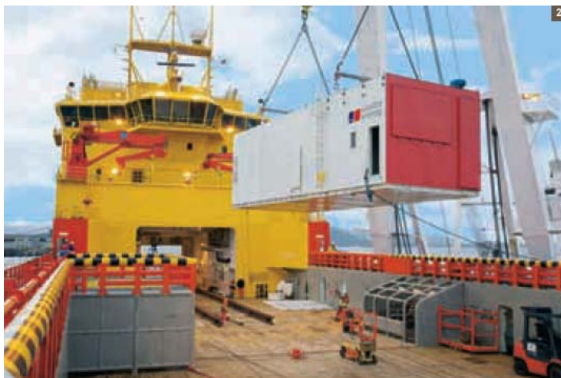
Fig. 7. Bränslecellssystemet från MTU Onsite Energy lyfts ombord på Viking Lady. [www.mtu-online.com]
