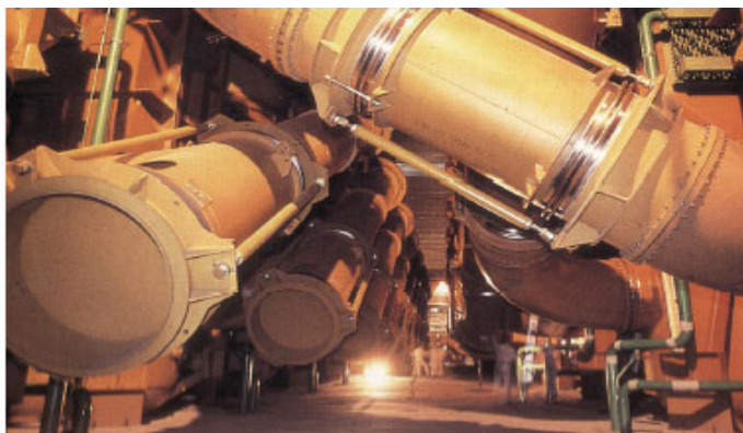
Rör innehållande filter, genom vilka \text{UF}_6 passerar.
