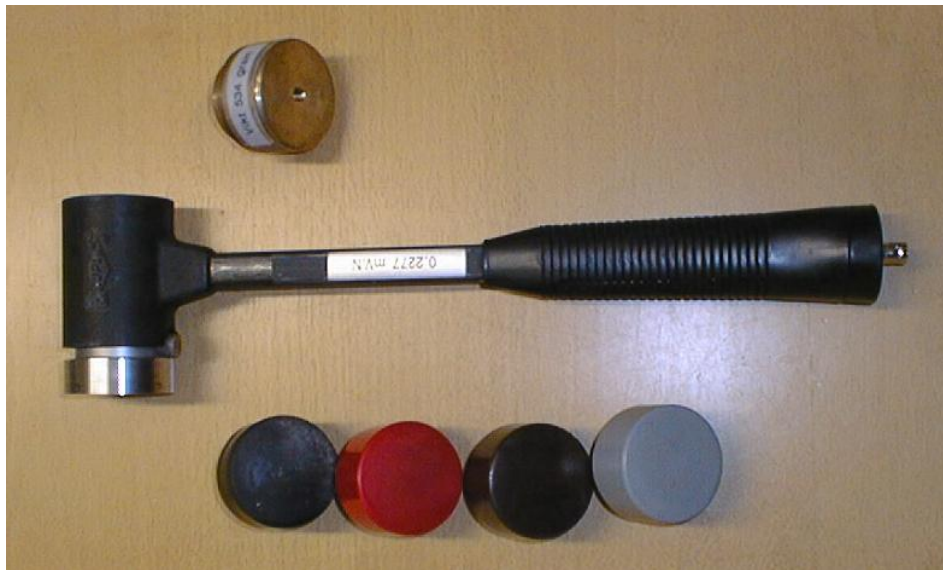
Figur 3. Närbild av en sk "modally tuned" hammare från PCB. Den har en inbyggd kraftgivare och kan förses med olika slagdynor av gummi och en extravikt. Även denna hammare är rekylfri.
