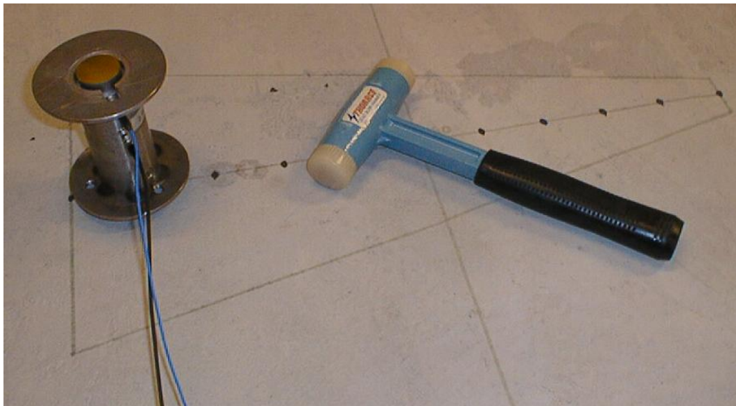
Figur 2. Närbild på det utvecklade kombinationshandtaget t.v. som mäter kraft i slaget och betongytans hastighet i slagriktningen. Dessa parametrar medger beräkning av betongytans punktimpedans. Hammararen är fylld med blykulor. Det gör den rekylfri så att inga studsar uppkommer.
