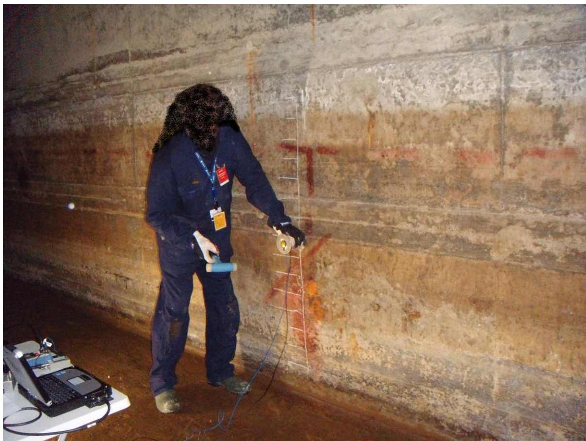
Figur 1. Mätplatsen i utrymme 0410. Den vertikala mätlinjen med punkt 1 överst är markerad med kritstreck. Rekylfri hammare (Thorace 2012) och det utvecklade kombinationshandtaget för mätning av kraft och hastighet användes i försök 1 och 2.
