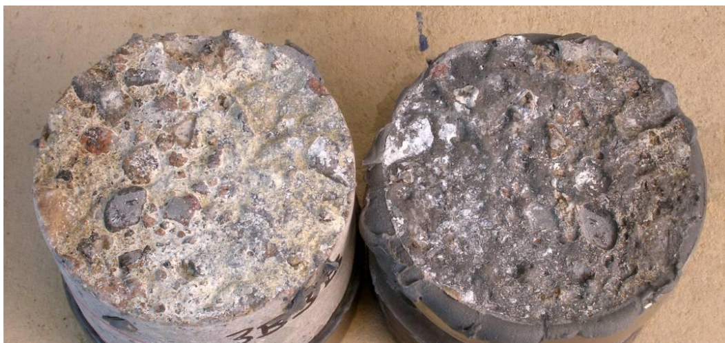
Figur 36: Brottyta, vidhäftningsprov 3B
