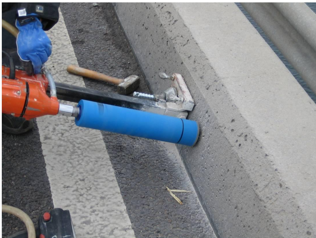
Figur 14: Termiskt sprutat zinkskikt efter 11 års exponering på Ölandsbron.
