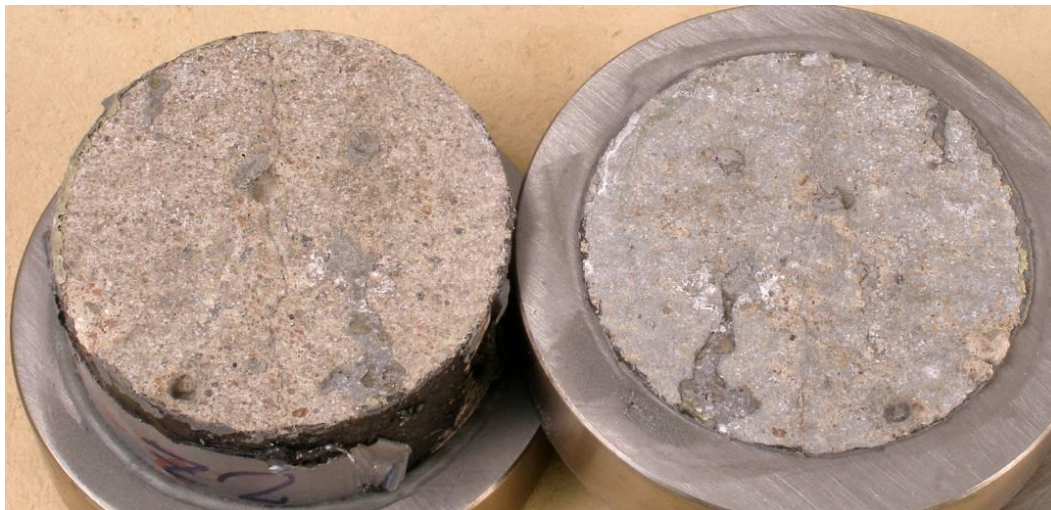
Figur 21: Brottyta, vidhäftningsprov Z2
