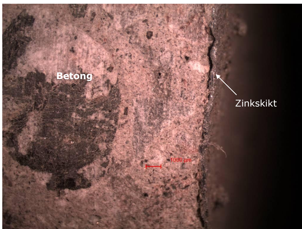
Figur 27: Tvärsnitt av betongkärna 1A (ovanför vattenyta) med zinkskikt.
