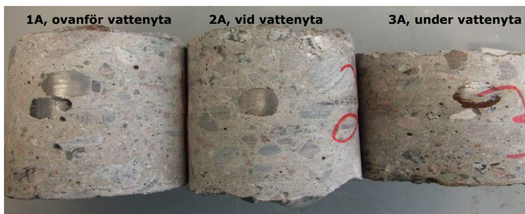
Figur 26: Utseendet hos armeringen i uttagna betongkärnor
