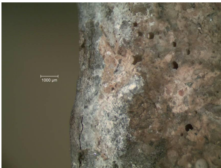
Figur 16: Tvärsnitt av korroderat zinkskikt där zinkjoner transporterats in i betongen ca 3 mm.
