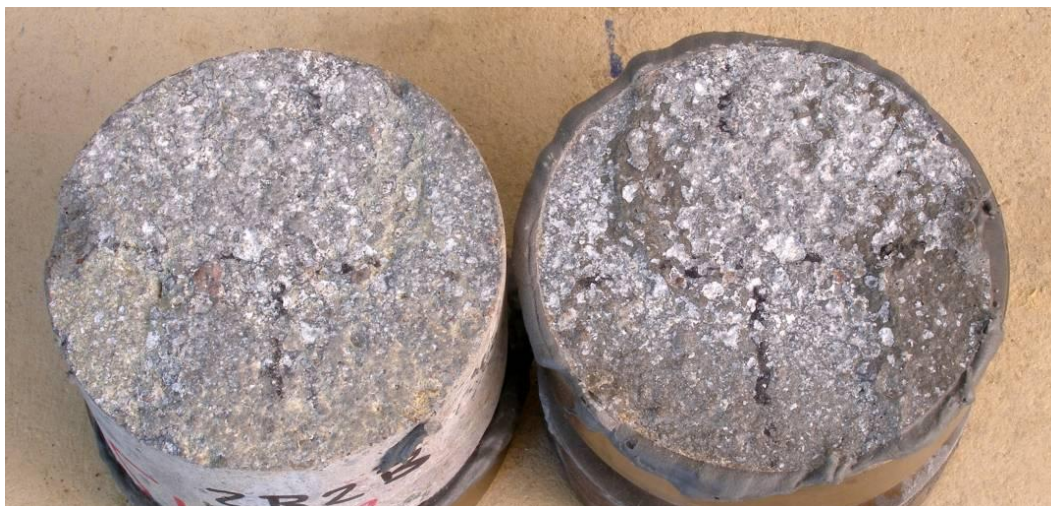
Figur 35: Brottyta, vidhäftningsprov 2B
