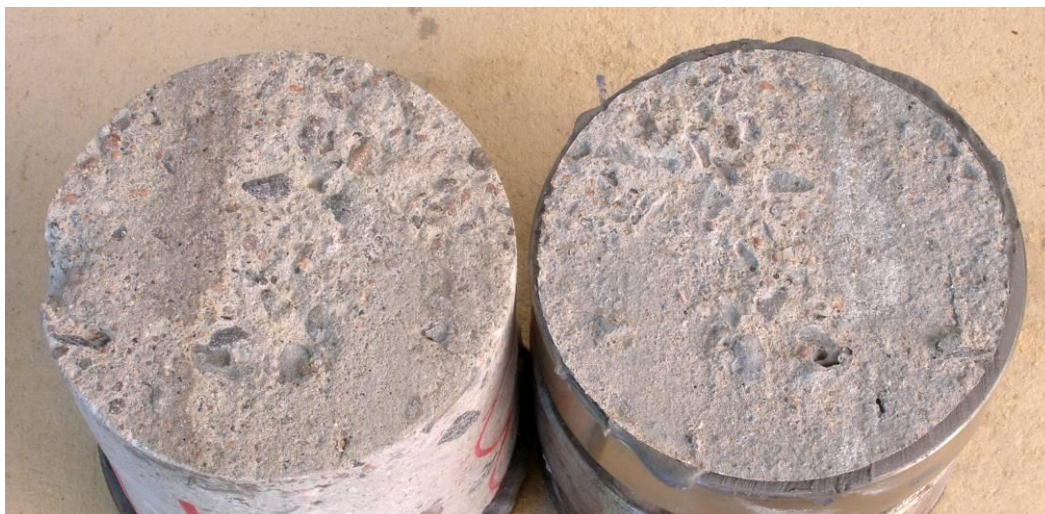
Figur 34: Brottyta, vidhäftningsprov 1B
