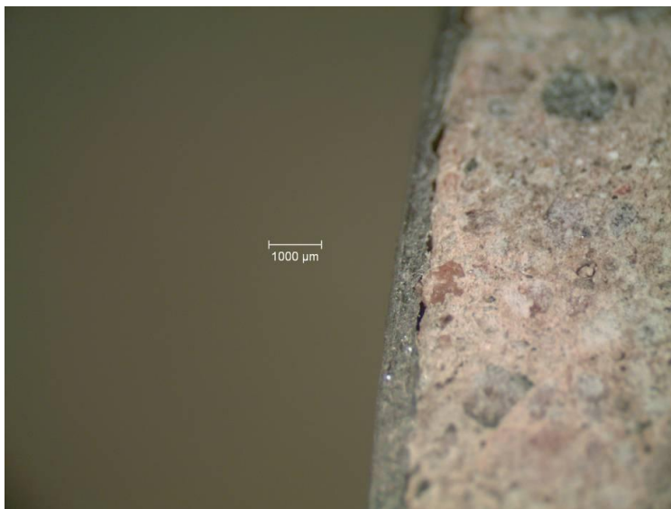
Figur 15: Tvärsnitt av zinkskikt och betongkärna. Zinkens tjocklek varierar mellan 300 och 700 \mu\text{m} . Ingen transport av zinkjoner in i betongen har konstaterats.
