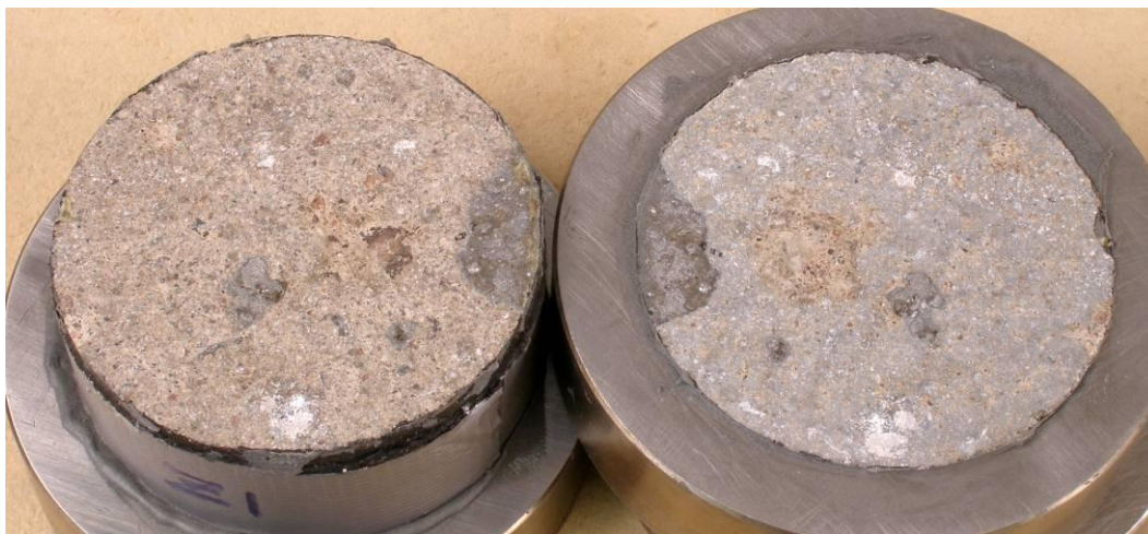
Figur 20: Brottyta, vidhäftningsprov Z1
