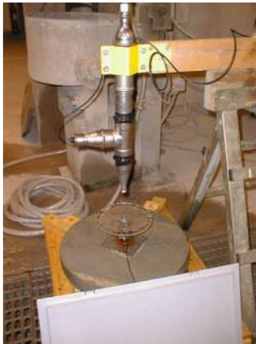
Figur B5.11 Försöksupställning vibrator med plexiglasplatta
