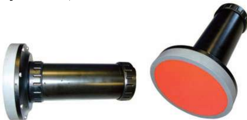
Figur 7.2 Sea-King Trittech 200/10-30 kHz Parametrisk sonar Längd 330 mm, diameter 200 mm
