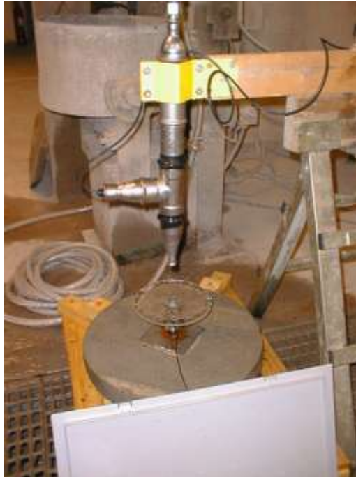
Figur 6.6 Försöksuppställning vibrator med plexiglasplatta
