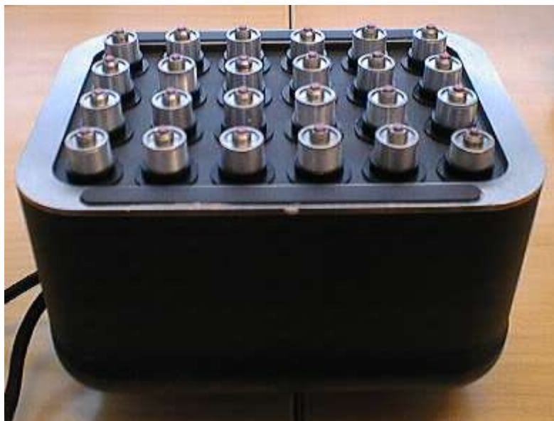
Figur 4.5 Sökare med 12 sändar- och 12 mottagarelement
