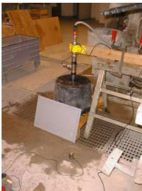
Figur B5.15 Vibratorn på golvet utplockad från försöksuppställningen
