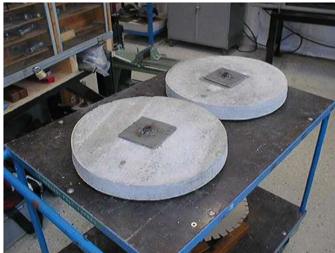
Figur 6.3 400 mm betongplattor med tjockleken 60 mm.
