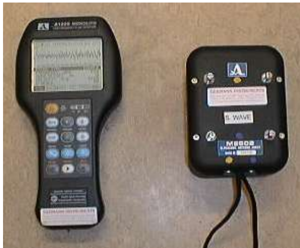
Figur 4.4 Huvudkomponenterna i A1220 systemet - Instrument och sökare. Kabel tillkommer.
