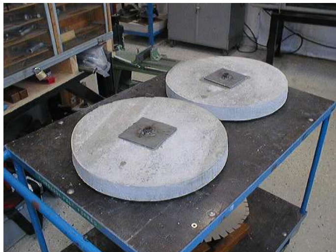
Figur B5.3 400 mm betongplattor med tjockleken 60 mm.
