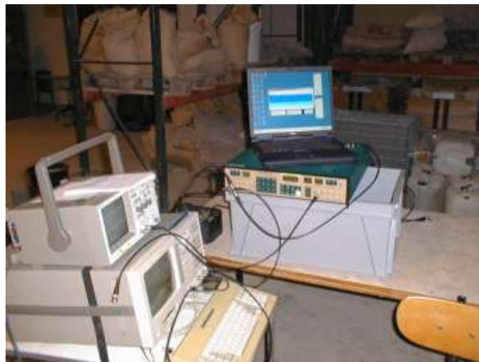
Figur B5.2 I försöken använd mätutrustning. DSA till vänster under oscilloskopet.
