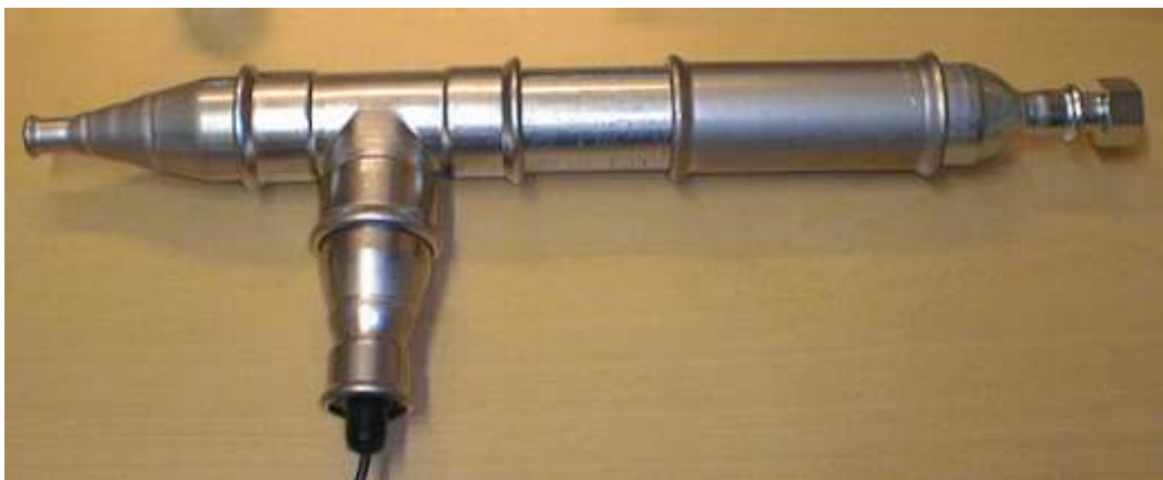
Figur B5.1 Sprutmunstycke med sensor i form av en 200 kHz transducer
