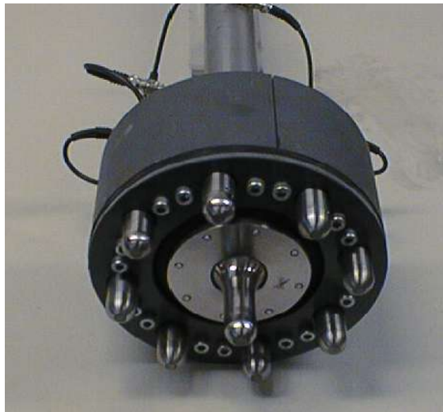
Figur 2.1 Sensor för impulsresponsmätningar, sändare i centrum. LTH 1999
