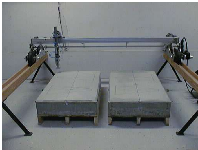
Figur 2.2 Scanner för automatiserad avsökning i rutnät.
