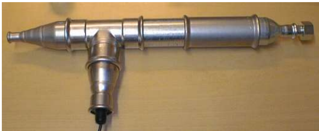
Figur 6.1 Sprutmunstycke med sensor i form av en 200 kHz transducer
