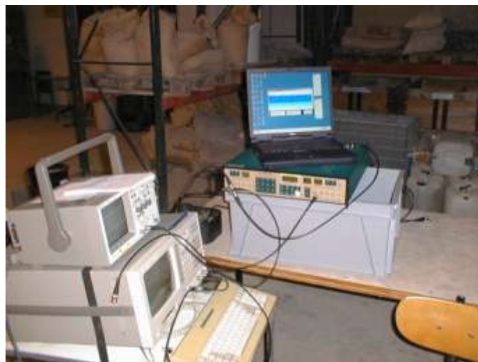
Figur 6.2 I försöken använd mätutrustning. DSA till vänster under oscilloskopet.
