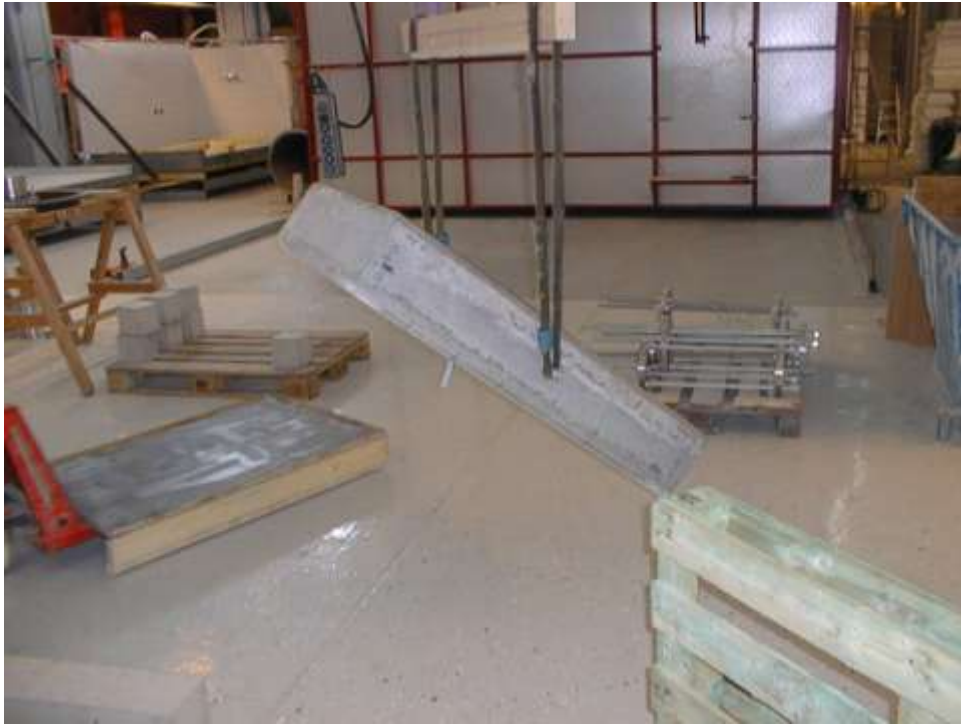
Figur 4.10 Det genomgående röret används vid vändning av provkropparna
