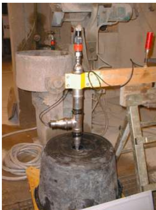
Figur B5.4 Försöksuppställning med stänkskydd
