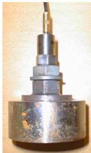
Figur 6.10 Accelerometer under stdet som vänts upp och ner jämfört med Figururen ovan. Accelerometern överst.
