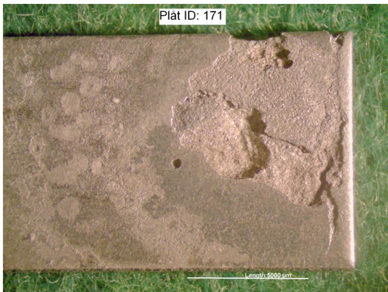
Figur 10. Lokala angrepp vid hörn på prov 171 (uttag 2), exponerat vid 73 % relativ fuktighet.
