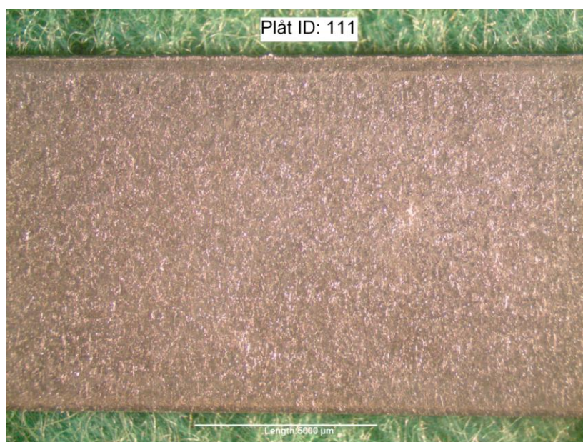
Figur 14. Oangripen yta på prov 111 (uttag 2), exponerat vid 95 % relativ fuktighet.
