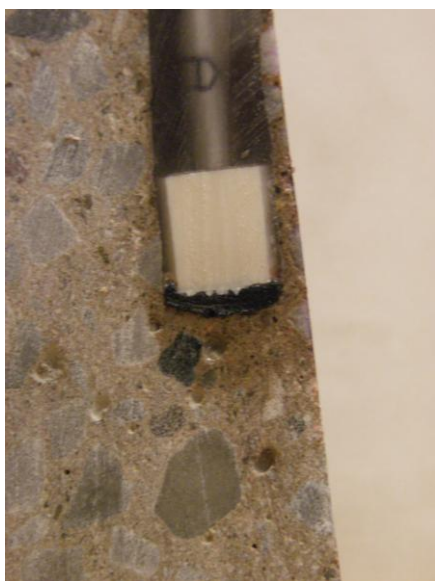
Figur 6.2.2.4 Snitt av borrhålet. På bilden syns den vita plastflänsen kring mätroret och den fastlimmade svarta gummipackningen.
