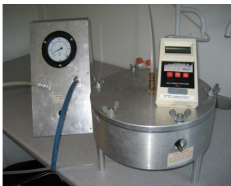
Figur 4.2.1.3 Utrustningen redo att användas. Tryckregulator till vänster.
