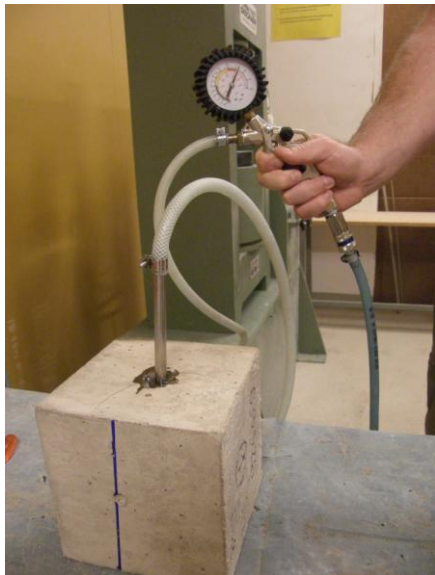
Figur 6.2.2.1 Betongkub försett med mätrör kopplat till tryckluft (ca 7 bar). Borrhålet var 20 mm i diameter. Epoxin syns som det mörkare partiet runt mätröret.
