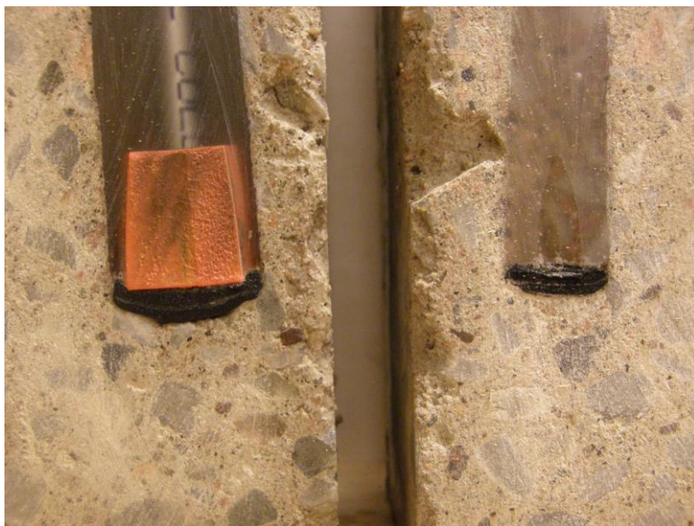
Figur 6.2.2.6 Borrhålssnitt. Till vänster syns flänsen (gummikork) och gummipackningen.
