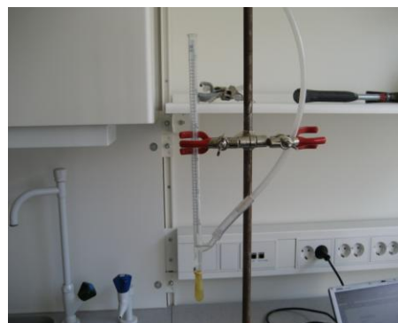
Figur 4.2.1.4 Gasflödet bestämdes m h a menisk i mätrör.
