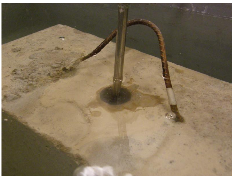
Figur 6.2.2.5 Betongprovkropp nedsänkt i vatten.
