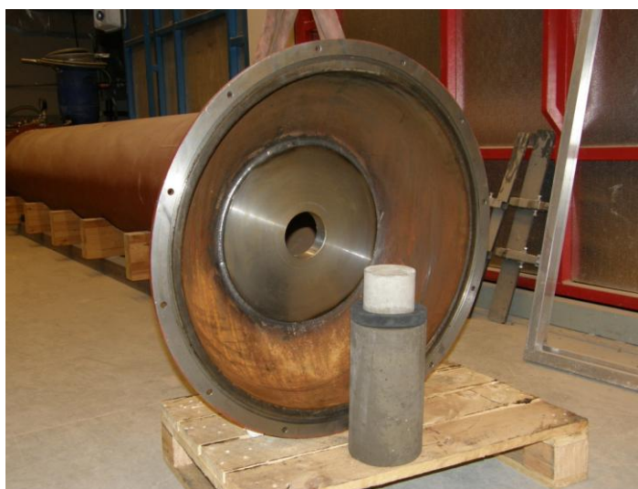
Figur 5.2 Provkropp och gavel med genomföring.
