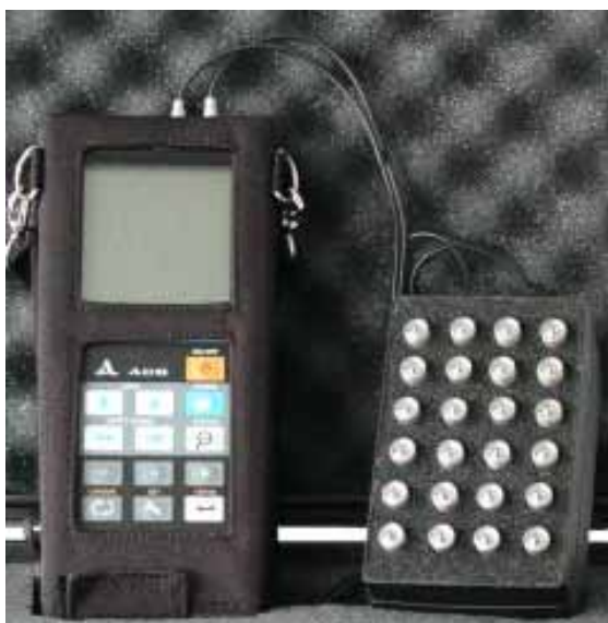
A 1220 Impact echo med skjuvvågor, sändare/mottagare t.h.
