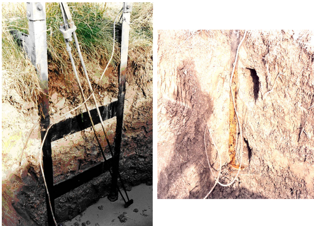
Figur 2 Stålstolpe med ansluten jordningslina och markprofil samt närbild av jordningslina. (Foto M Forssander)
