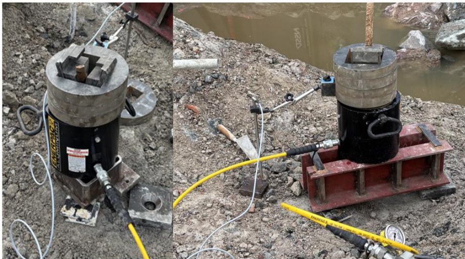
Figur 6. Provningsuppställningen som användes vid provdragningarna. den nedre vänstra bilden visar provningsuppställningen med den mindre lastfördelande anordningen.
