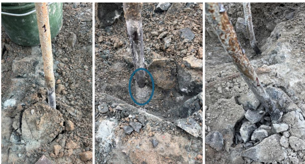
Figur 9. Bilder på bergförankring 15 (vänster och mitten) samt 18 (höger) släta stänger som gått till kombinerat brott, ytbrott i berg samt brott i injekteringsbruk. Den mittersta bilden visar bergförankring 15 efter att den lösa bergmassan avlägsnats. Den blå ringen i visar injekteringsbruk runt stängen där den går ner i berget. Även de delar av dessa bergförankringar som utgjort förankringslängden är i bra skick utan några synliga korrosionsangrepp.
