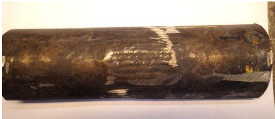
Bild 1:1. Läge för svetsreparationer.
