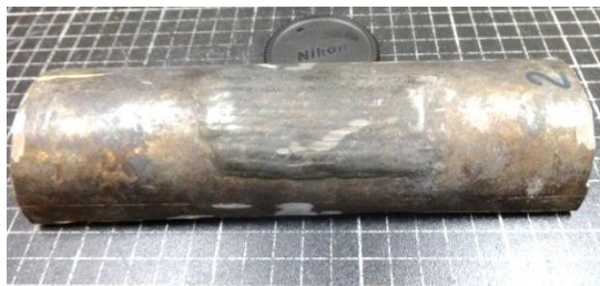
Bild 2:1. Läge för svetsreparationer.
