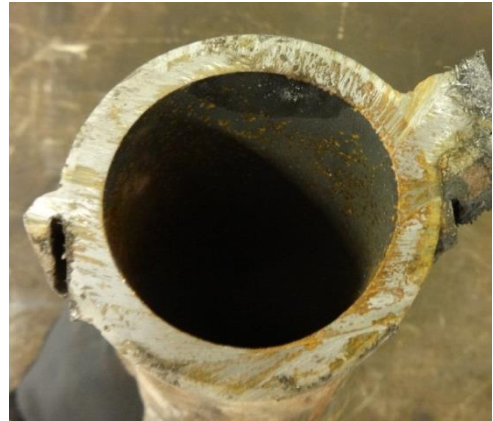
Bild 3:4. Utseende hos tvärsnitt. Ingen ovalisering.
