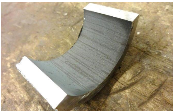
Bild 9:3. Utseende hos insida. Inga spår av korrosion.
