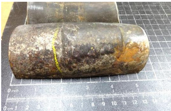
Bild 12:1. Läge för svetsreparationer.
