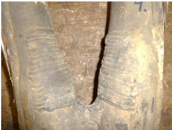
Bild 4:1. Läge för svetsreparationer.
