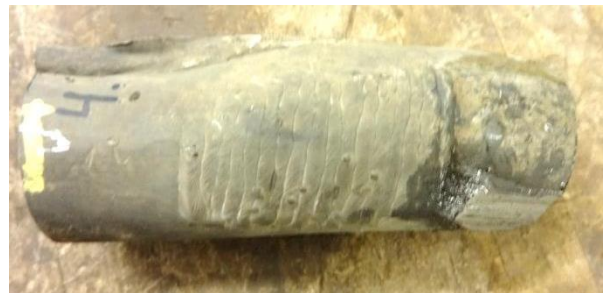
Bild 4:2. Undersökt prov från högra reparationen i bild 4:1.
