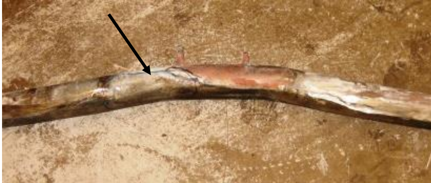
Bild 6:1. Läge för svetsreparation.
