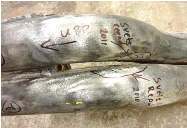
Bild 9:1. Läge för svetsreparationer.
