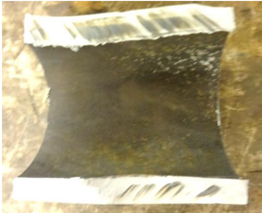
Bild 3:3. Utseende hos insida. Inga spår av korrosion.
