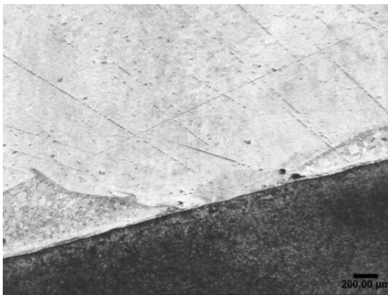
Bild 3:5. Svetsreparation tangerar innerkomponenten (mörk i bildens underkant).
