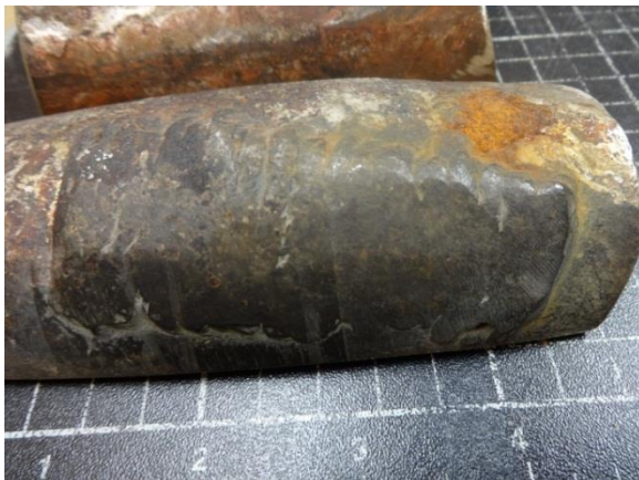
Bild 11:1. Läge för svetsreparationer.
