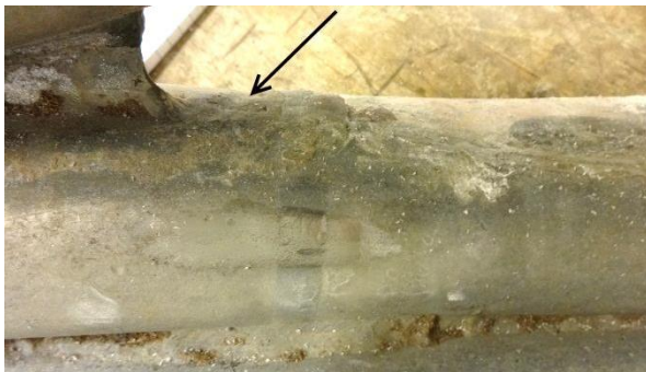
Bild 8:1. Läge för svetsreparationer.
