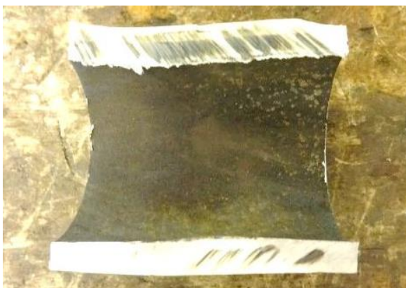
Bild 4:3. Utseende hos insida. Inga spår av korrosion.
