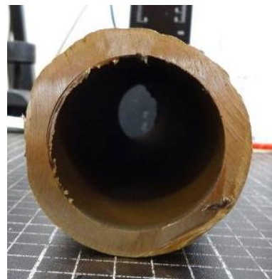
Bild 5:4. Utseende hos tvärsnitt. Ingen ovalisering.
