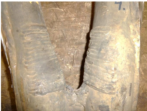
Bild 3:1. Läge för svetsreparationer.
