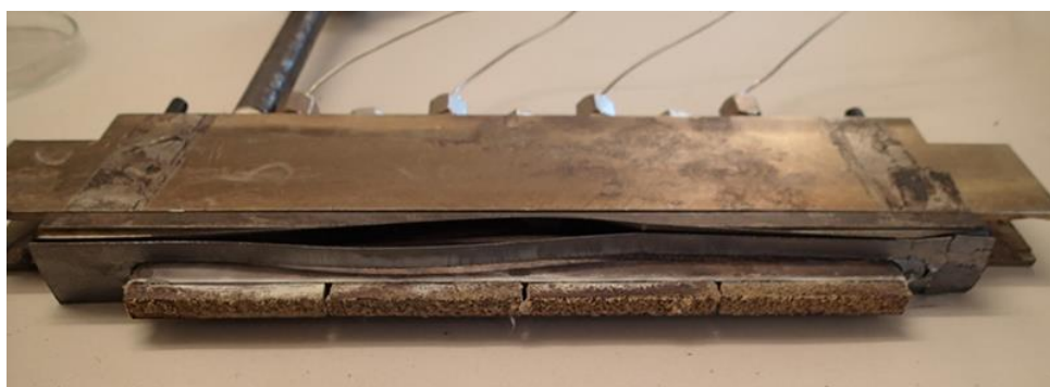
Figur 3 Vattenfalls fensond (före och efter exponering)
