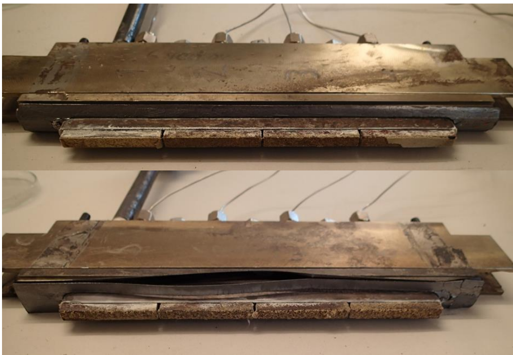
Figur 16 Sond (med fyra provbitar) efter exponering med 9% SLF. Överst Drag 3, nederst Eva 1
