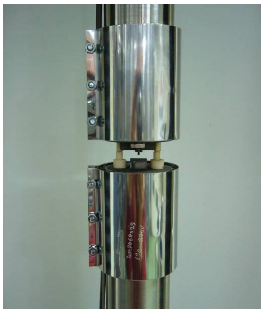
Figur 40. Resistansspolarna är omslutna av höljen av rostfritt stål.
