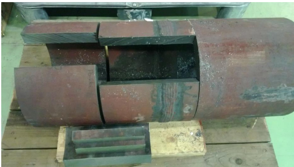
Figur 42. Svetsat rör av 10CrMo9-10 utan driftpåkänning efter att provmaterialet har sågats ut.
