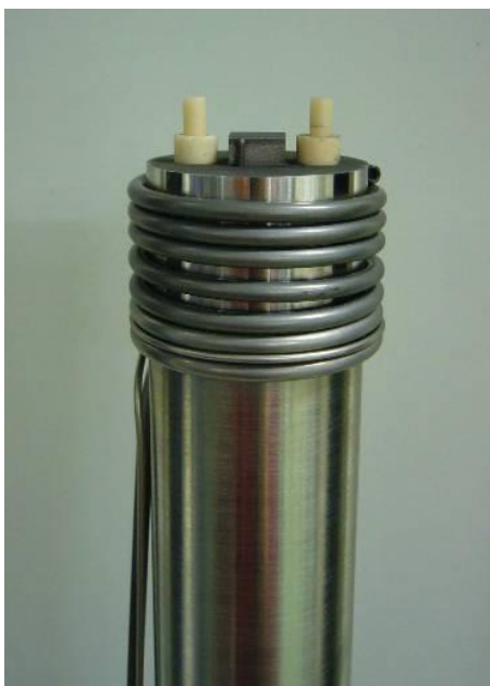
Figur 39. Nedre del av rigg, delar av keramisk extensometer, resistansspole och undre laststång.
