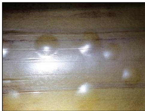
Figur 46 Blåsor kan ha större diameter och sitta mindre tätt
