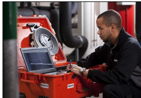
Figur 31 Provningsingenjör med utrustning för digital röntgen
