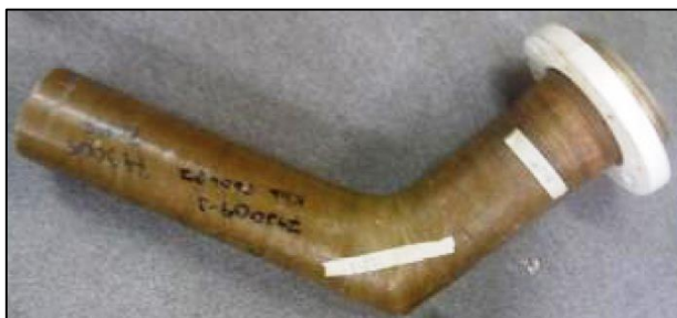
Figur 35 GAP ledning med böj. Invändig lining av PVDF
