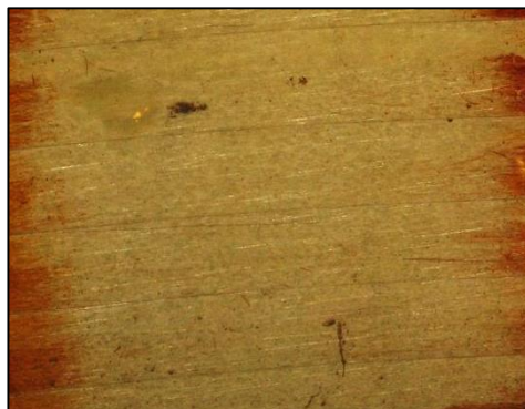
Figur 83 En skrubbermantel med synliga märken från tillverkningsformen
