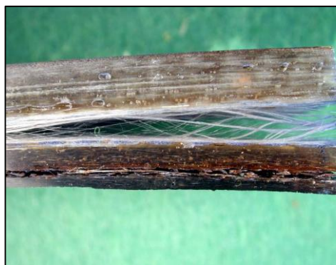
Figur 52 Tvärsnitt av ett delaminerat laminat
