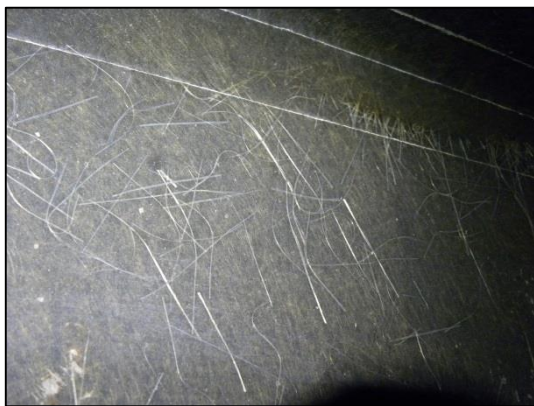
Figur 88 Ytligt liggande fibrer kan bero på lösa fiberknippen vid tillverkningen
