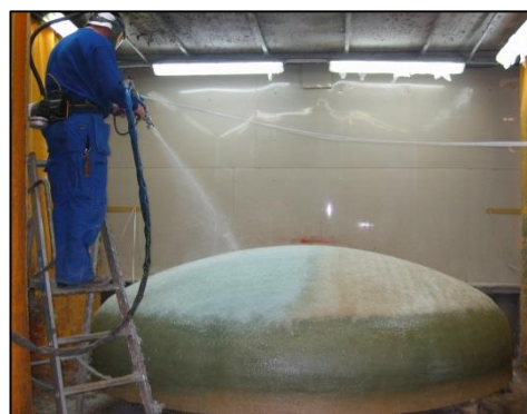
Figur 9 För tillverkning av mer komplicerade geometrier kan huggen glasfiber blandad med harts sprutas på en form
