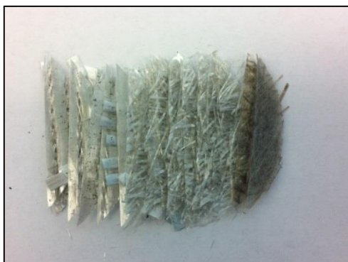
Figur 13 Avbränning av hartsmatrisen ger en tydlig bild av laminatuppbyggnaden och glashalten i de olika delarna av laminatet kan bestämmas
