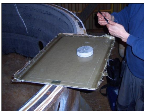
Figur 16 En ny rondell med samma storlek som provuttaget borrar ut ur ett nytt laminat
