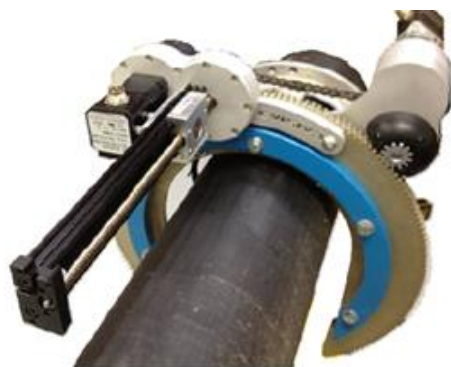
Figur 42 Utrustning för automatisk scanning med mikrovågteknik
