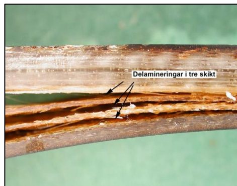
Figur 54 Delamineringar kan ske i olika skikt inne i laminatet
