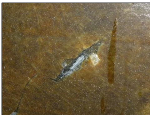
Figur 61 Djup slagskada i spärrskiktet
