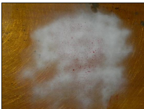
Figur 23 Penetrant (röd) på en mantel i en skrubber efter att framkallare (vit) applicerats
