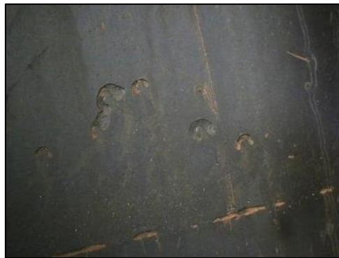
Figur 87 Efter en tids drift nöts det tunna hartsskiktet bort från luftblåsorna och groparna blir synliga
