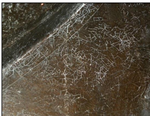
Figur 78 Exempel på små ytsprickor. Även märke från släppfilm syns i bilden som ett diagonalt streck
