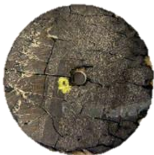
Figur 56 Laminat missfärgat av överhettning
