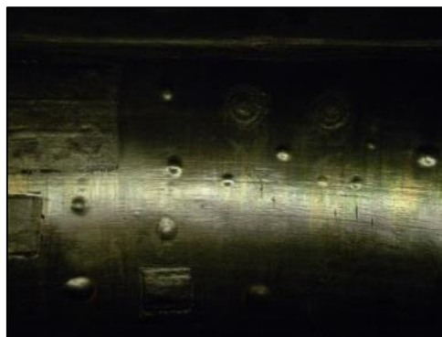
Figur 50 Blåsor på insidan av en skrubbermantel
