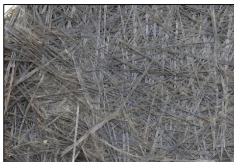
Figur 58 Laminat efter kraftig överhettning
