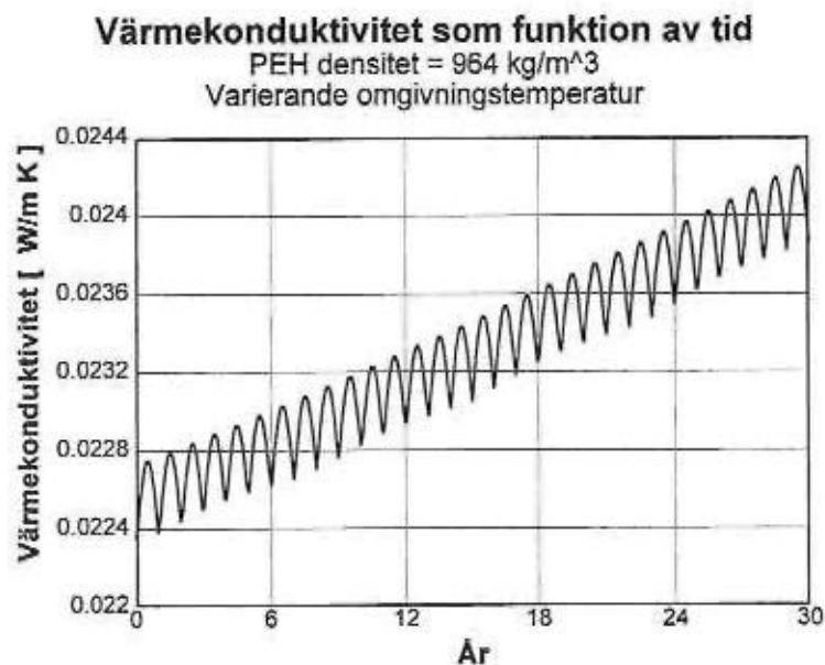
Figur 12. Termisk medelkonduktivitet i isolerskummet under en 30 års period då omgivningens temperatur varierar mellan 5^\circ\text{C} och 17^\circ\text{C} .
