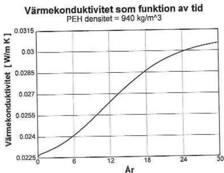
Figur 16. Termisk konduktivitet i isolerskummet under en tidsperiod av 30 år.
