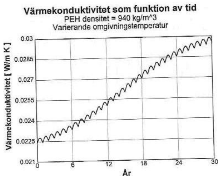
Figur 20. Termisk medelkonduktivitet i isolerskummet under en 30 års period då omgivningens temperatur varierar mellan 5^\circ\text{C} och 17^\circ\text{C} .
