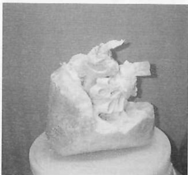
Figur 8-3. Foto på ett block PUR-skum med prov av vattenblockerande tejp som delvis frilagts.
