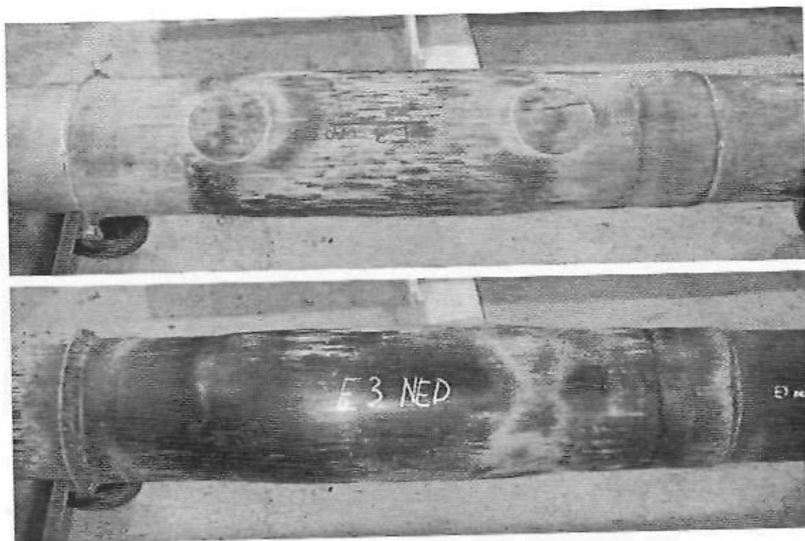
Figur 4.27 Elektrosvetsmuff efter 1000 förskjutningscykler i 0 – 32 mm. Fusion welded joint after 1000 displacement cycles in 0 – 32 mm.
