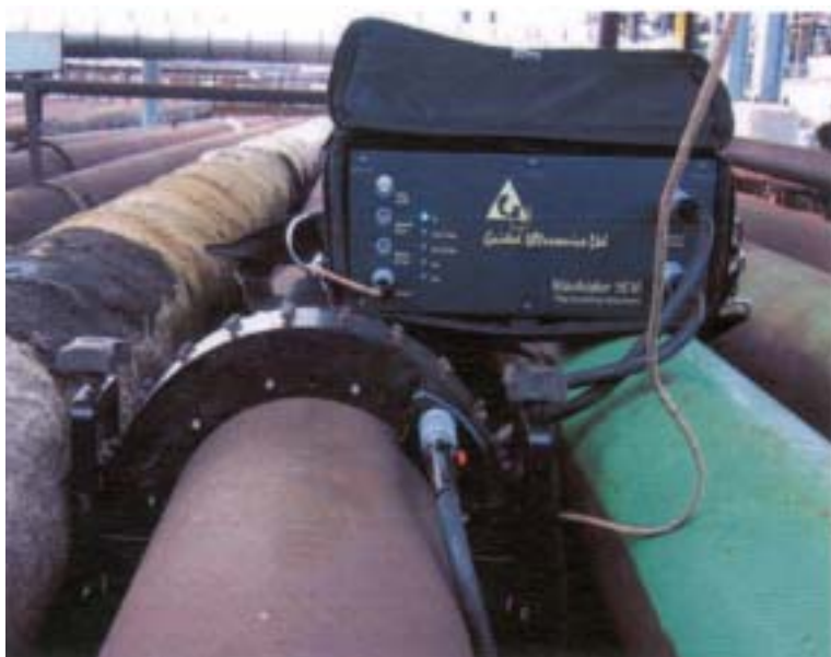
Figur 3. Ultraljudprovning av stålrör enligt Forcemetoden, ref [2].
