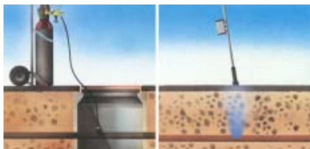
Figur 13. Läcksökning med vätgas, ref [7].
