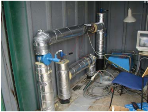
Figur 2.6 a,b: Inredning av mätcontainern. a) (Till vänster): Anslutning till huvudledningen. b) (höger): Fjärravläsningsenhet och tryckgivare.
