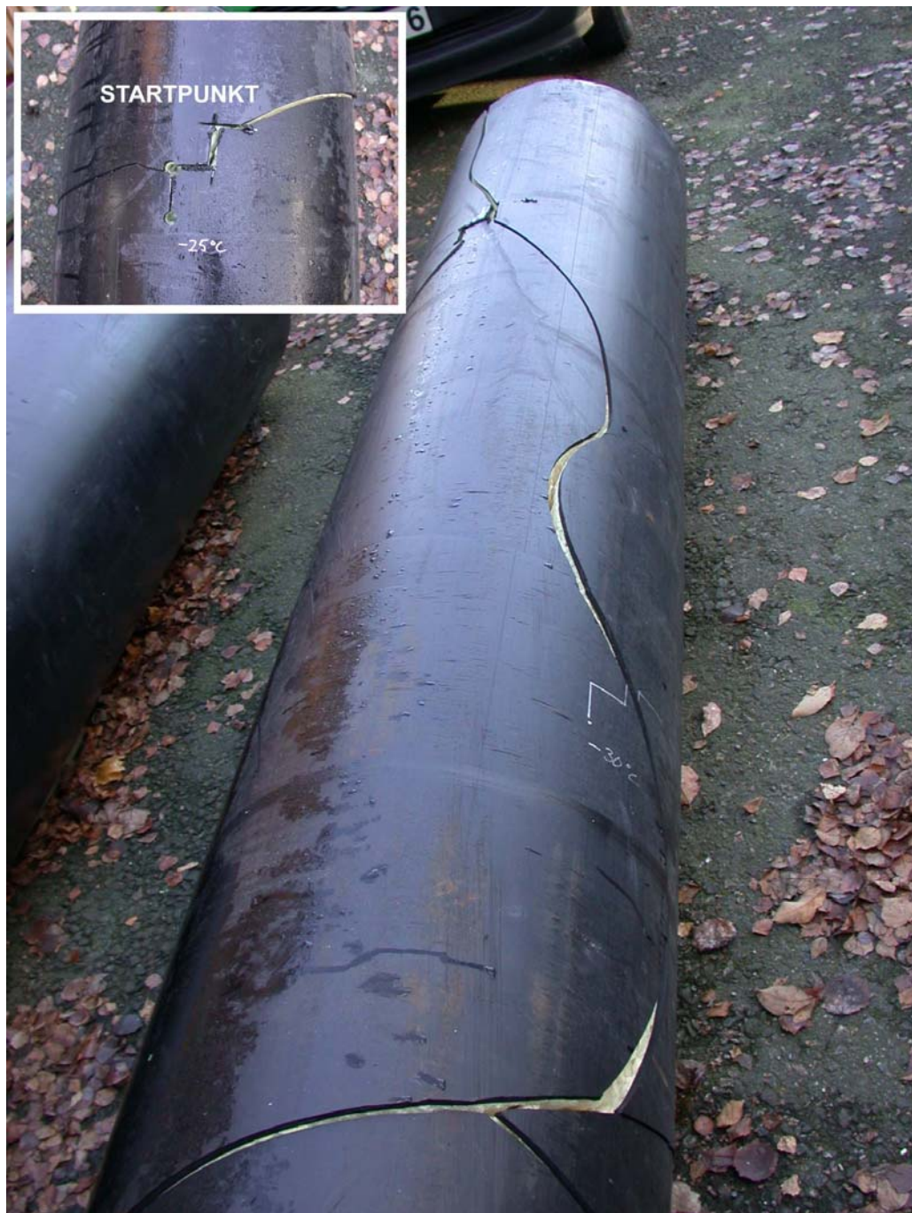
Bild 12 Hanteringsprov med brott
