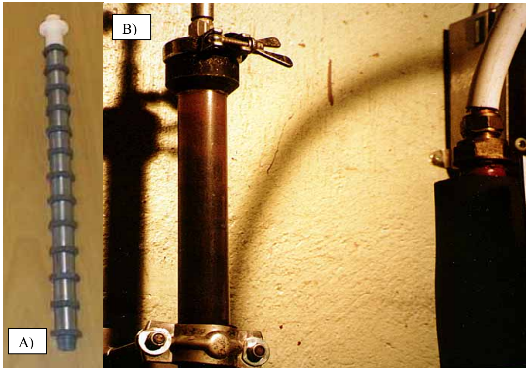
Figur 4: Korrosionscellen med flödesmätare. Provhållaren (A) som sitter i provbehållaren (B).
