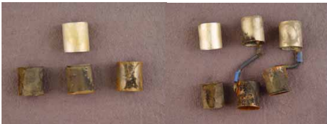
Figur 5: Provcylindrar efter 0,47 år exponering. Högst upp på bilden cylindrar av rostfritt stål och längst ned cylindrar av kolstål. Till vänster i bilden fritt exponerade provcylindrar och till höger hopkopplade provcylindrar. Bredvid de hopkopplade cylindrarna visas som jämförelse fritt exponerade cylindrar.
