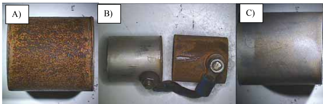
Figur 6: Provcylindrar efter 0,74 år exponering. A) Fritt exponerad kolstålscylinder, B) Elektriskt hopkopplade cylindrar av kolstål och rostfritt stål, och C) Fritt exponerad cylinder av rostfritt stål.
