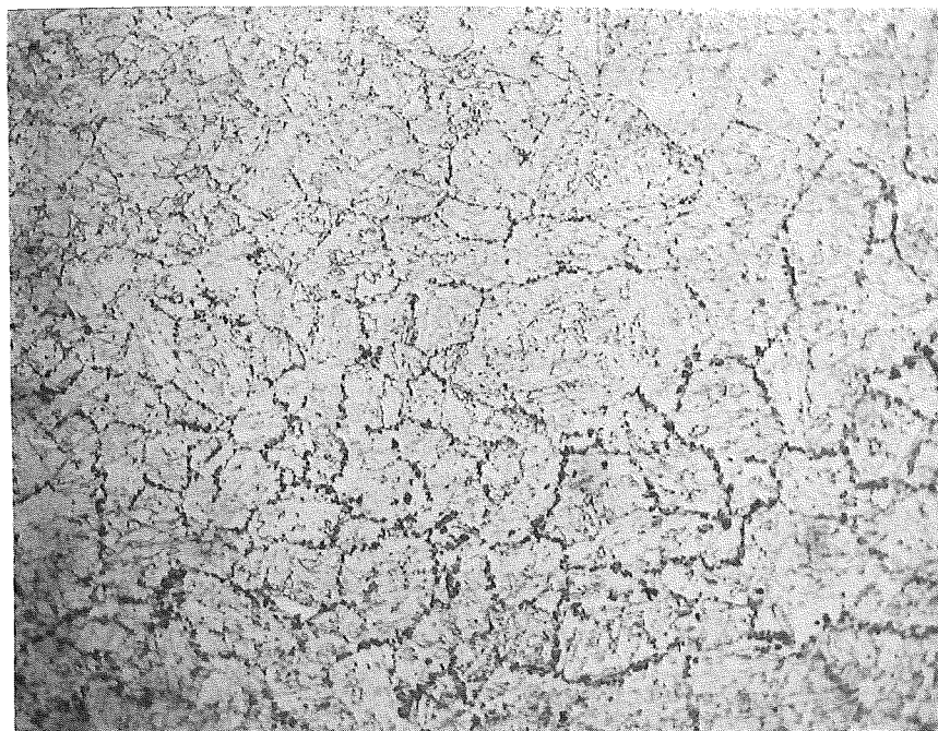
Fig. 21. Område med korngränsutskiljning i överhettade zonen ur oglödgat rör nr. 2. 138x.
