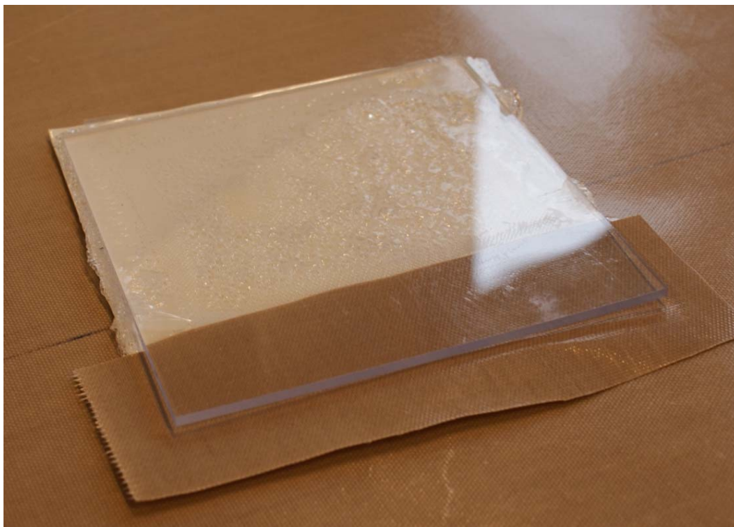
Figur 5. Makrolonprov från första lamineringstesten i andra testserien. Många luftbubblor har utvecklats.
