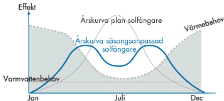
Figur 4. Principiell fördelning av årsutbytet för en Blenda solfångare och en konventionell solfångare.
