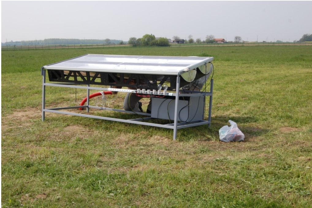
Figur 8. Stagnationsprovning av den nya hybridabsorbatoren i Kroatien.
