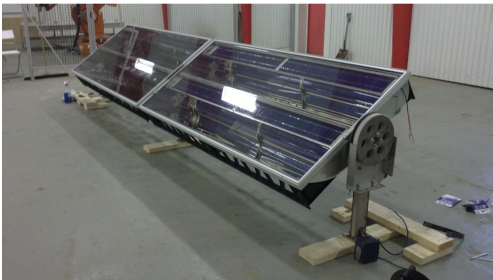
Figur 24. Komplet moduls avsedd för solföljning genom vridning omkring en öst-västlig
