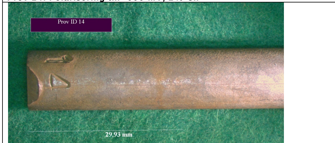
Prov 14: Skada på Prov ID 14 från borttagningen av täckskikt.
