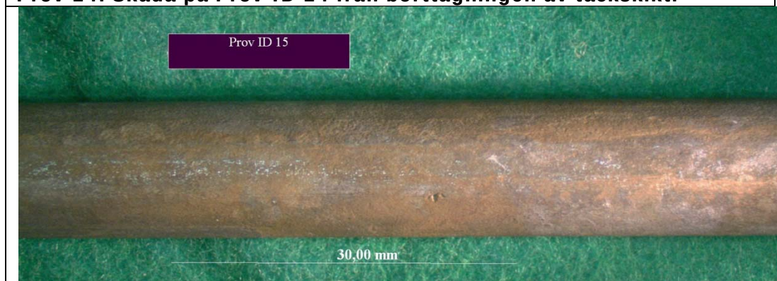
Prov 15: Polarisering till -700 mV, 2 % Cl. Små korrosionsangrepp.
