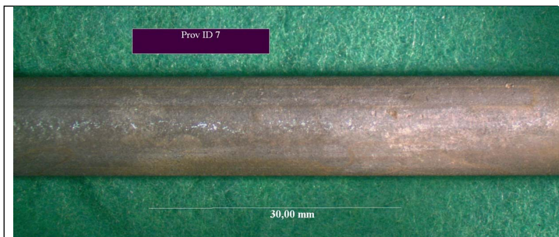
Prov 7: Polarisering till -400 mV, 1 % Cl. Små korrosionsangrepp vid kanten (kortsidan).
