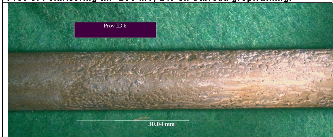
Prov 6: Polarisering till -100 mV, 2 % Cl. Utbredd gropfrätning.
