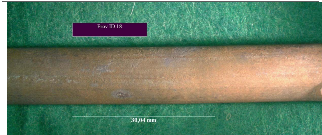
Prov 18: Skada på Prov ID 18 från borttagningen av täckskikt.
