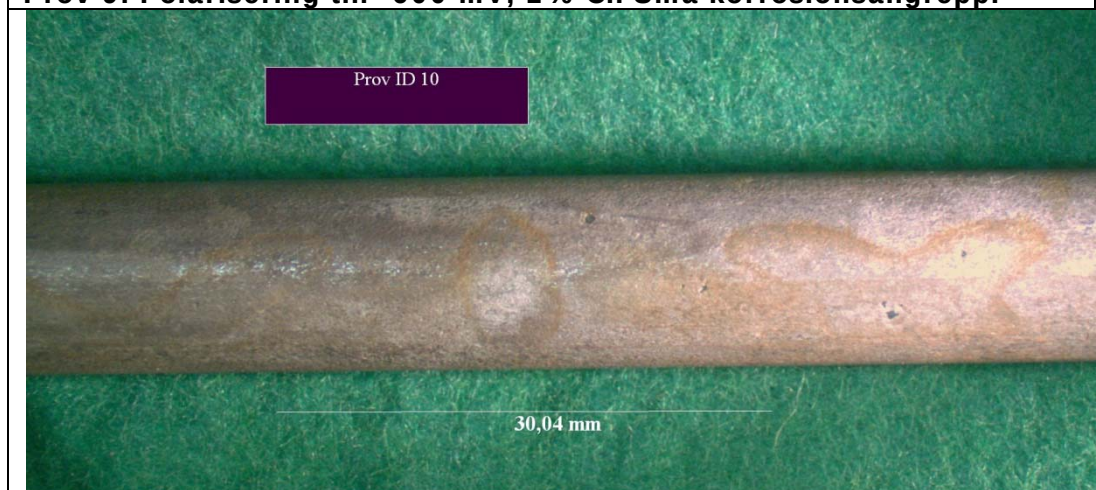
Prov 10: Polarisering till -700 mV, 1 % Cl. Små korrosionsangrepp.
