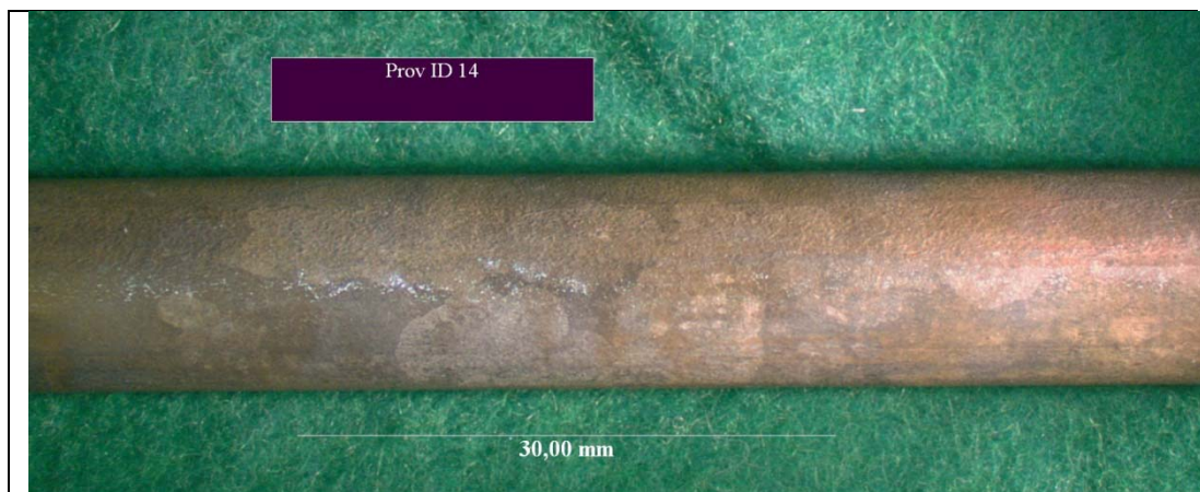
Prov 14: Polarisering till -600 mV, 2 % Cl.
