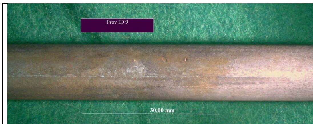
Prov 9: Polarisering till -600 mV, 1 % Cl. Små korrosionsangrepp.
