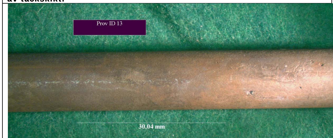
Prov 13: Polarisering till -500 mV, 2 % Cl. Små korrosionsangrepp.
