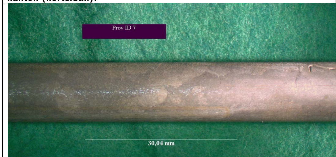
Prov 7: Skada på Prov ID 7 från borttagningen av täckskikt.
