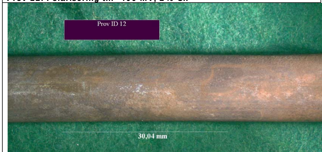
Prov 12: Polarisering till -400 mV, 2 % Cl. Skador från borttagningen av täcksikt.
