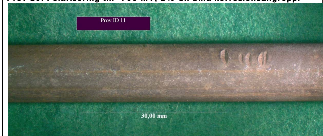
Prov 11: Polarisering till -800 mV, 1 % Cl. Skador från borttagningen av täcksikt.
