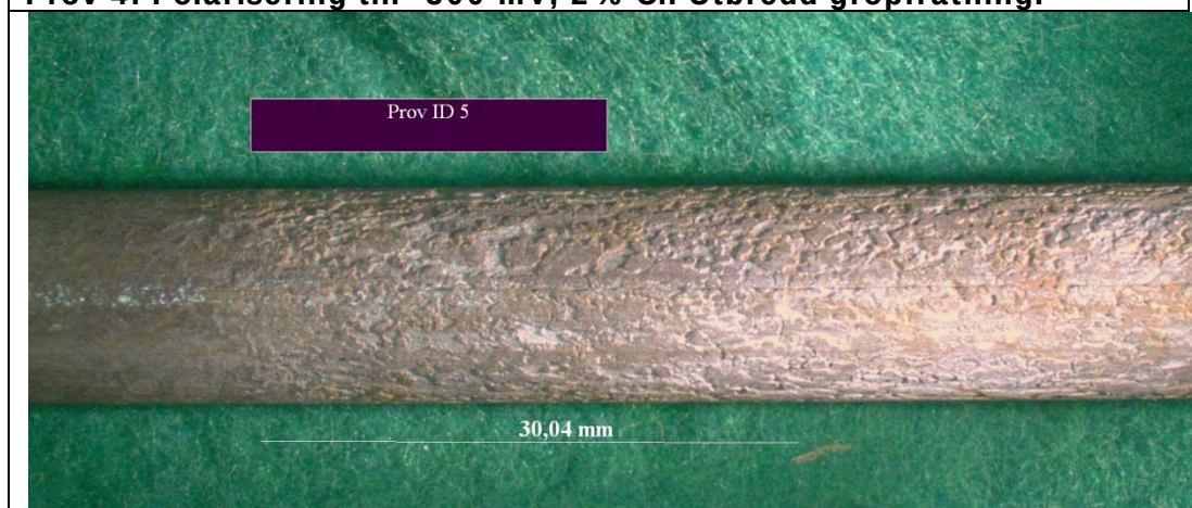
Prov 5: Polarisering till -200 mV, 2 % Cl. Utbredd gropfrätning.
