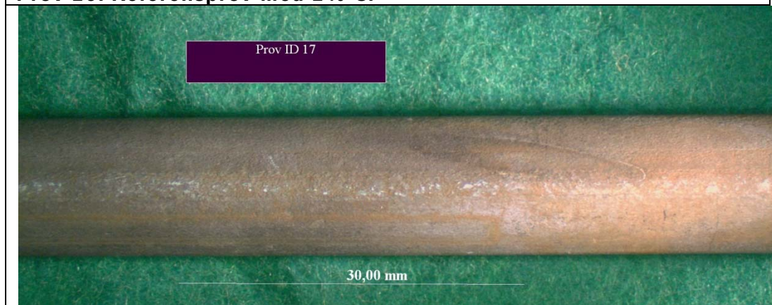
Prov 17: Polarisering till -800 mV, 2 % Cl
