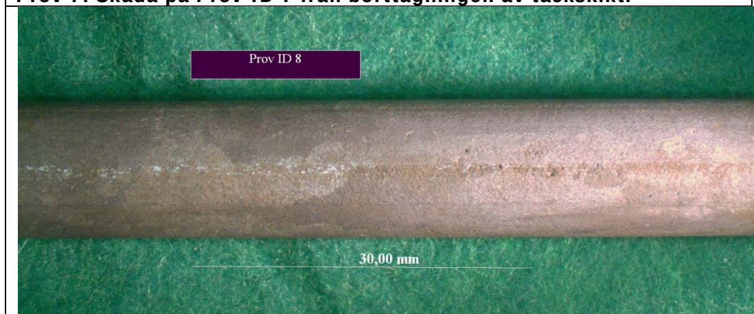
Prov 8: Polarisering till -500 mV, 1 % Cl. Små korrosionsangrepp.
