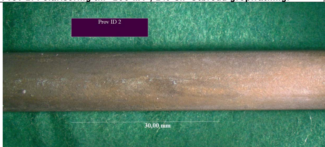
Prov 2: Polarisering till -200 mV, 1 % Cl.
