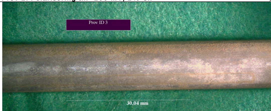
Prov 3: Polarisering till -300 mV, 1 % Cl.
