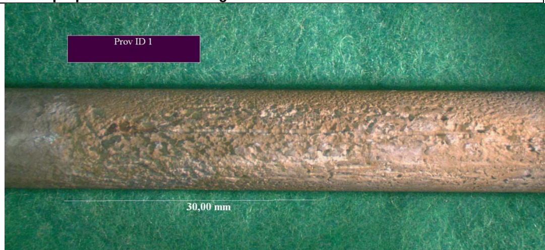
Prov 1: Polarisering till -100 mV , 1 % Cl. Utbredd gropfrätning.
