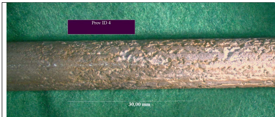
Prov 4: Polarisering till -300 mV, 2 % Cl. Utbredd gropfrätning.
