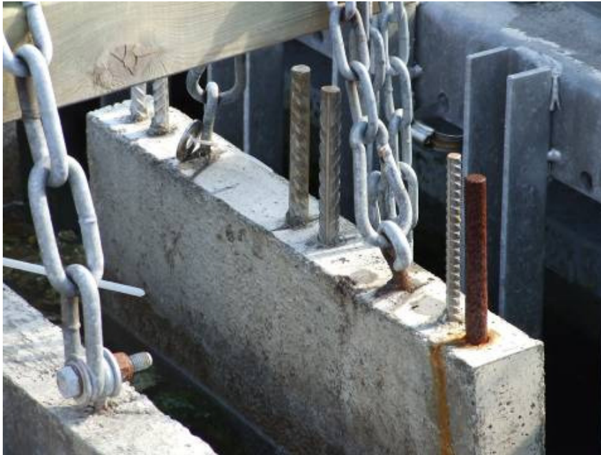
Figur 11 Bilden visar delvis ingjutna provstänger under exponering från flotten.
