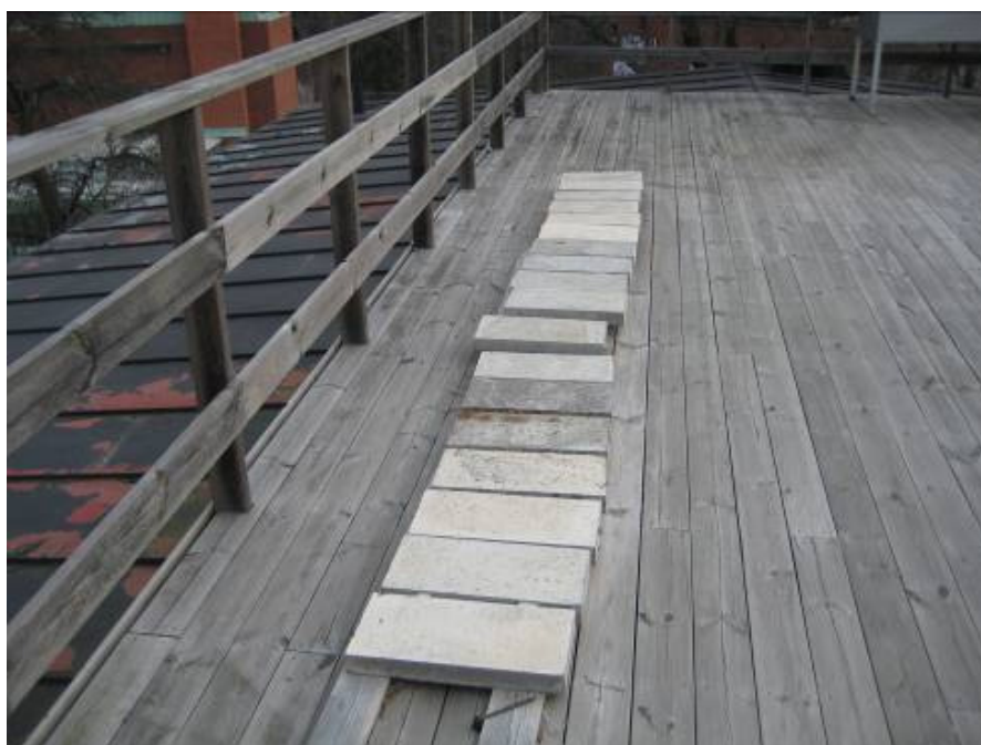
Figur 13 Utomhusexponering av provstänger av rostfri armering och kolstål ingjutna i betongblock med höga kloridhalter.
