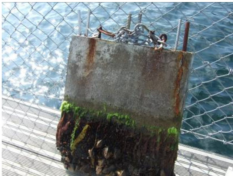
Figur 19 Utseendet hos ett betongblock med utstickande provstänger efter två års exponering i havsvatten.
