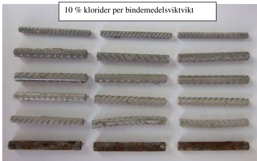
Figur 28 Utseendet hos provstänger av rostfritt stål och kolstål efter två års exponering utomhus ingjutna i betong (OPC C45/55, vbt 0,45) med 10 % klorider
