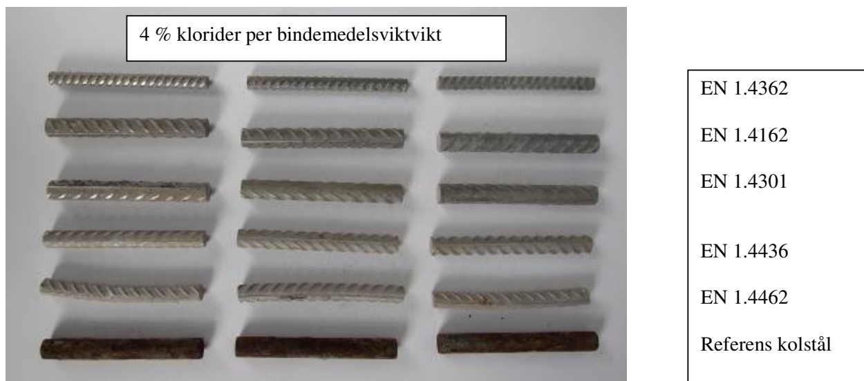
Figur 31 Utseendet hos provstänger av rostfritt stål och kolstål efter två års exponering utomhus ingjutna i betong (PFA C32/40, vbt 0,45) med 4 % klorider.
