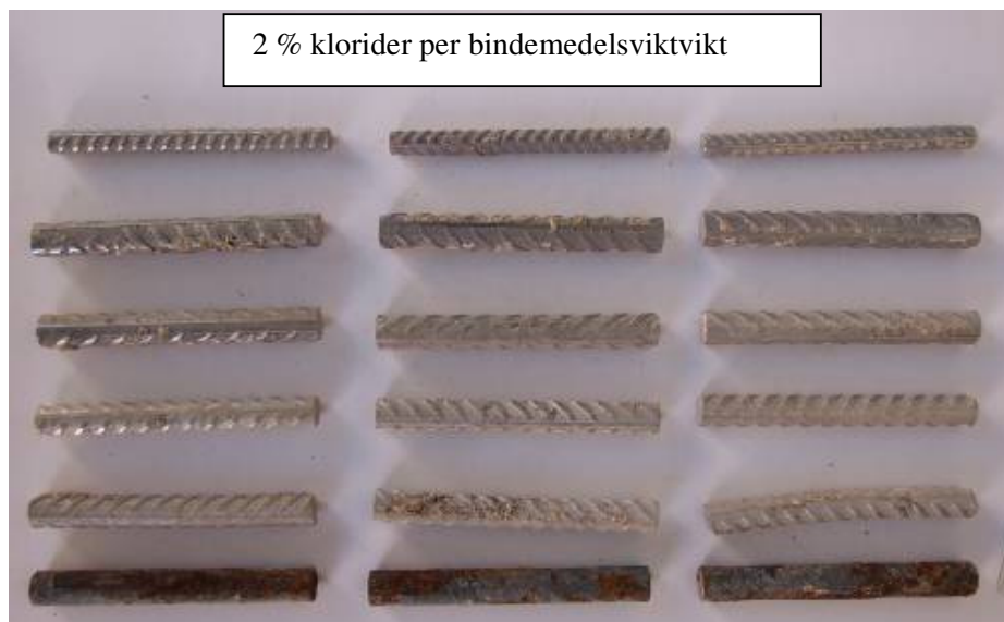
Figur 36 Utseendet hos provstänger av rostfritt stål och kolstål efter två års exponering utomhus ingjutna i betong (GGBFS C32/40, vbt 0,45) med 2 % klorider
