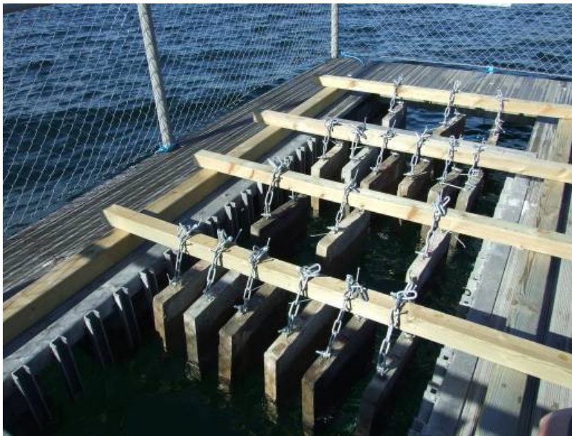
Figur 8 Bilden visar hur betongblocken exponeras delvis nedsänkta i havsvatten från flotten vid Bohus Malmö.
