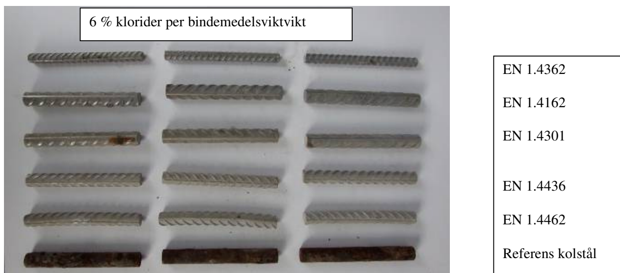
Figur 32 Utseendet hos provstänger av rostfritt stål och kolstål efter två års exponering utomhus ingjutna i betong (PFA C32/40, vbt 0,45) med 6 % klorider
