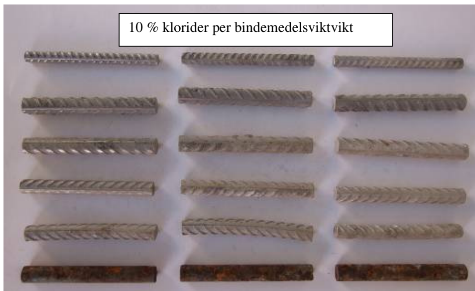
Figur 34 Utseendet hos provstänger av rostfritt stål och kolstål efter två års exponering utomhus ingjutna i betong (PFA C32/40, vbt 0,45) med 10 % klorider
