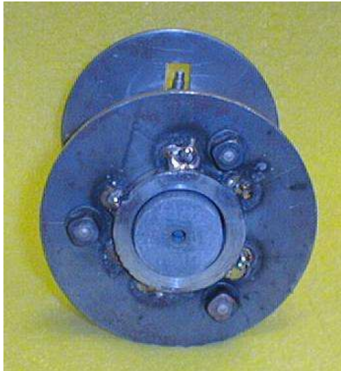
Figur 19. Kombinationshandtaget sett underifrån. Den runda plattan i mitten är geofonens plasthylsa
