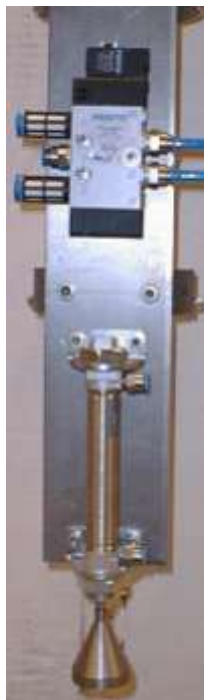
Figur 31. Elektromekanisk ventil med tryckluftcylinder monterad på skanner
