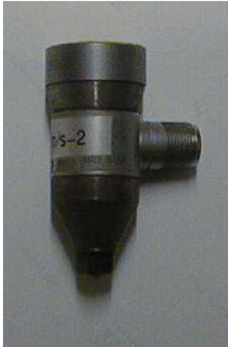
Figur 13. Accelerometer med hårdmetallspets
