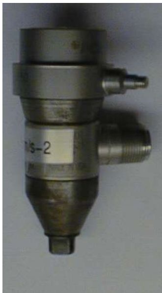
Figur 23. Impedanshuvud bestående av kraftgivare och accelerometer.
