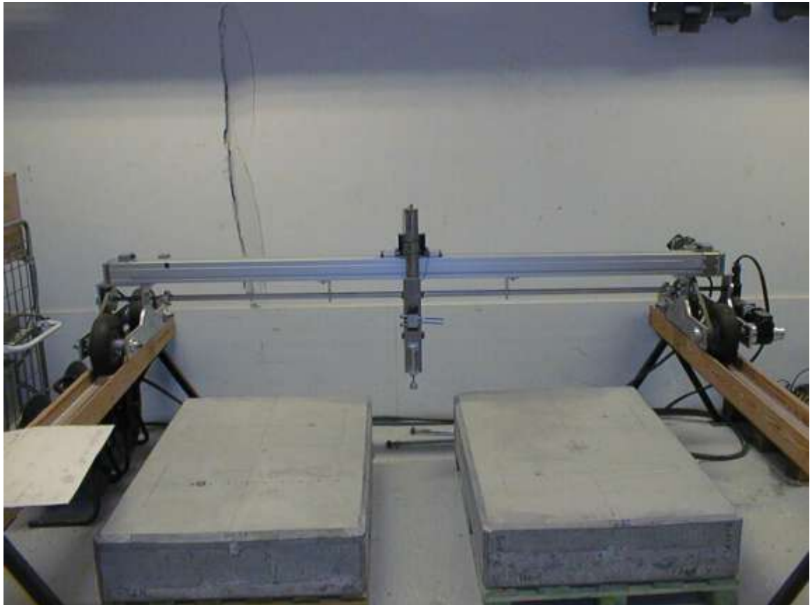
Figur 32. Tryckluftscylindern monterad på skannern för genomförande av avbildande försök baserat på resonansfrekvenser i delaminerad betong.
