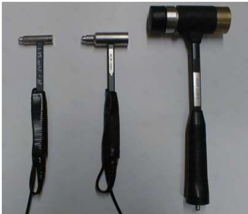
Figur 12. De tre använda hammartyperna L, M och S
