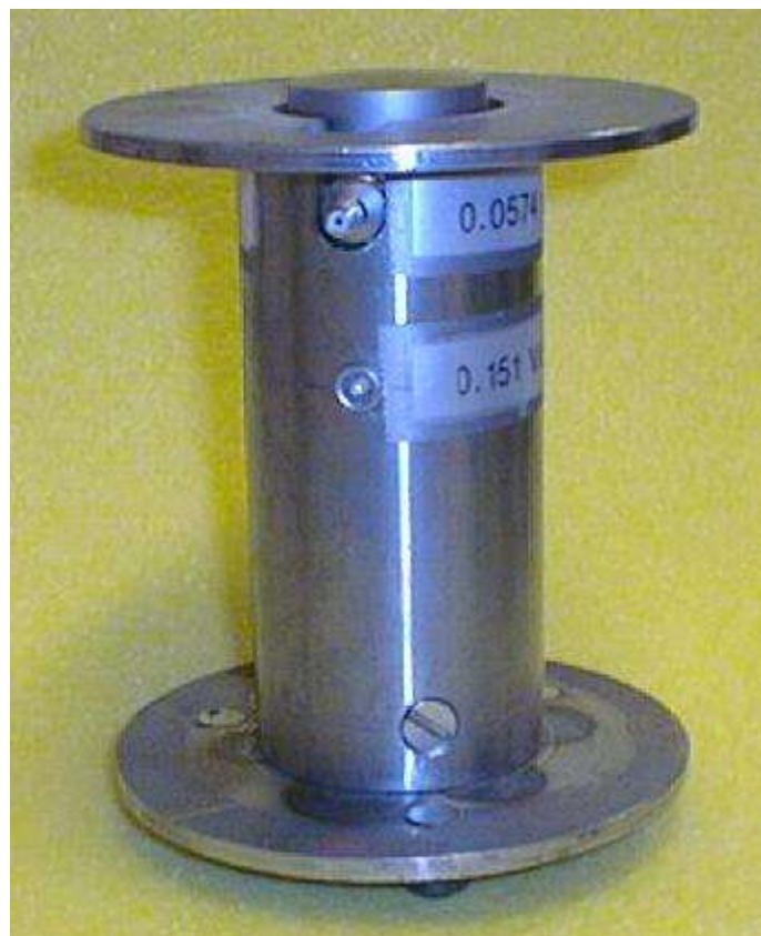
Figur 18. Impedanshuvud med kraft- och hastighetsgivare
