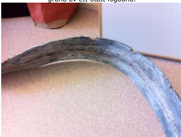
Figur 5.16 Ett gammalt PVC-fogband från kylvattenvägarna på Ringhals. Fogbandet kändes mycket styvt och hade förlorat sin flexibilitet. Samma fogband har även utvärderats i en annan rapport [7], med slutsats att valet av mjukgörare varit felaktigt och därför påverkat fogbandets livslängd negativt.
