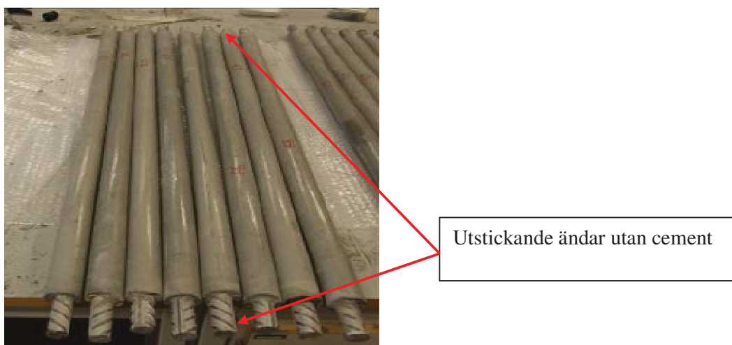
Figur 3 Provkroppar för korrosionsprovning i tunnlar (Test specimens for corrosion testing in tunnels)
