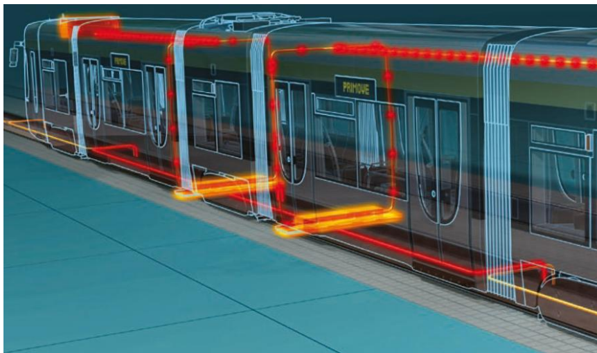
Figur 3.7 Bombardiens induktiva elöverföringssystem "Primover" med strömförsörjningskabel och upptagningsspolar, här tillämpat på tåg. Källa Bombardier
