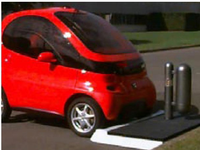
Figur 3.6 Bilden visar en demonstrationsbil samt laddstation för induktiv laddning med en s.k. "large air-gap charger".
