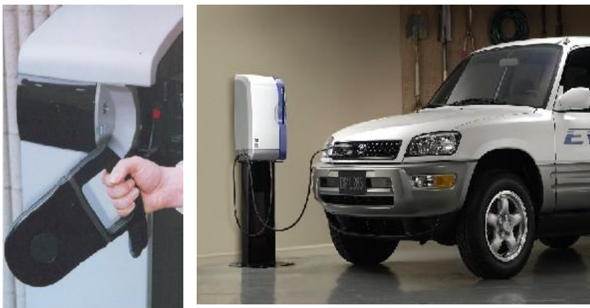
Figur 3.4 Kontakt för induktiv laddning (till vänster), Laddstation för induktiv laddning (till höger).
