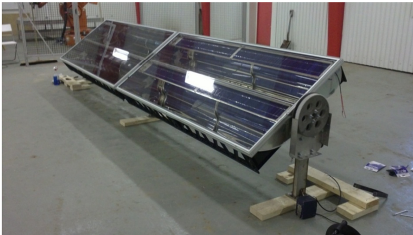
Figur 7. En solföljande prototyp som består av två moduler med en total area of 4,6 m 2 . Bilden visar hur solcellerna speglar sig i reflektorn.
