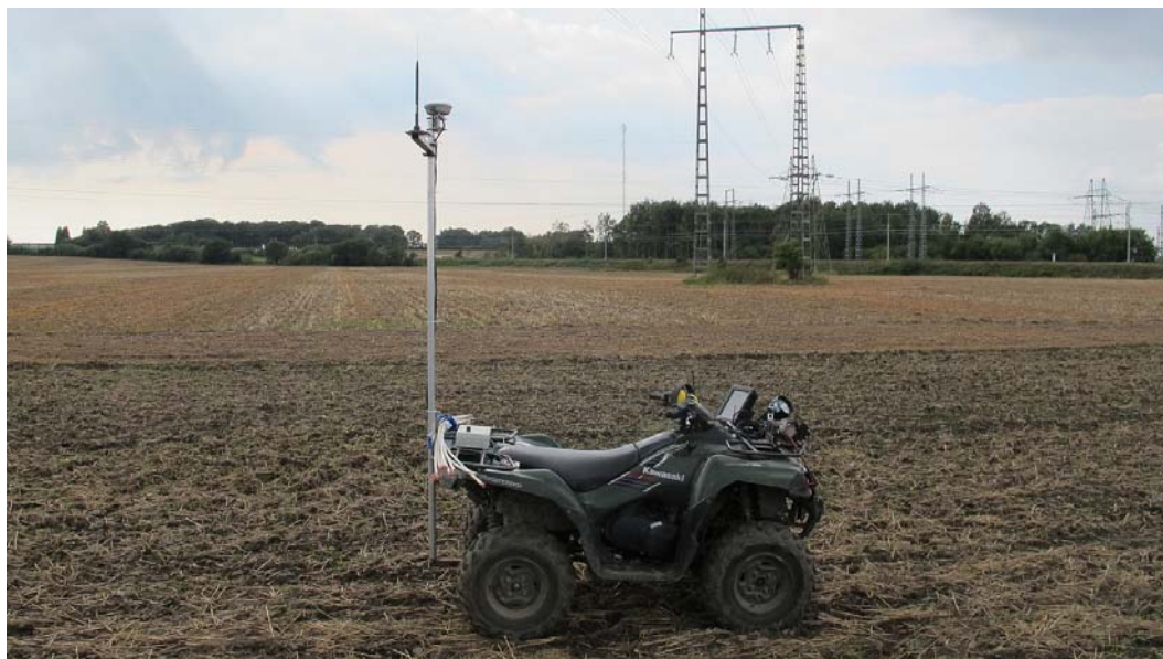
Figur 1 Bilden visar utrustningen som användes för att sampla GNSS-positioner på fälten. Utrustningen bestod av en GNSS-utrustning som monterades på en terränggående motorcykel.
