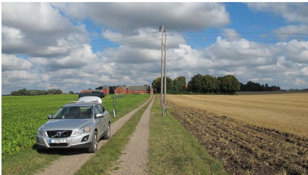
Figur 15 Antenner uppställda för mätning, 15 m från 50 kV ledningen.
