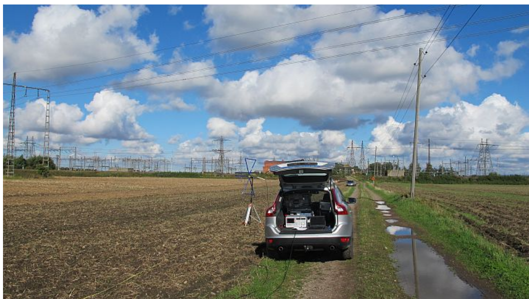
Figur 10 Mätning med Bilog-antenn i Position 2, 20 m från 130 kV ledningen och 5 m från distributionsledningen.
