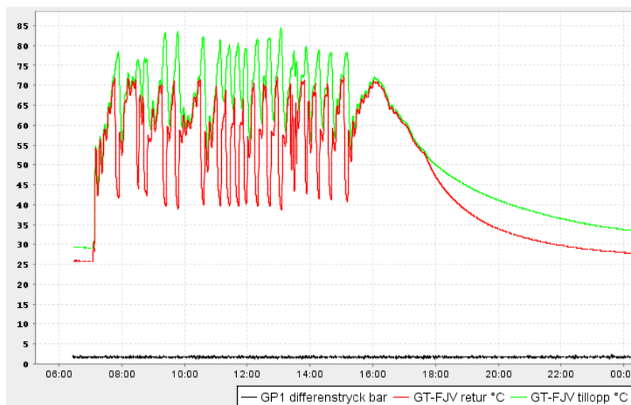
Figur 18 visar temperatursvängningarna för anläggningen i Gårdsten. I figuren motsvarar röd linje "GT-FJV retur °C" solvärmeanläggningens kalla sida och "GT-FJV tillopp °C" redovisar solvärmeanläggningens varma sida, tilloppet.
