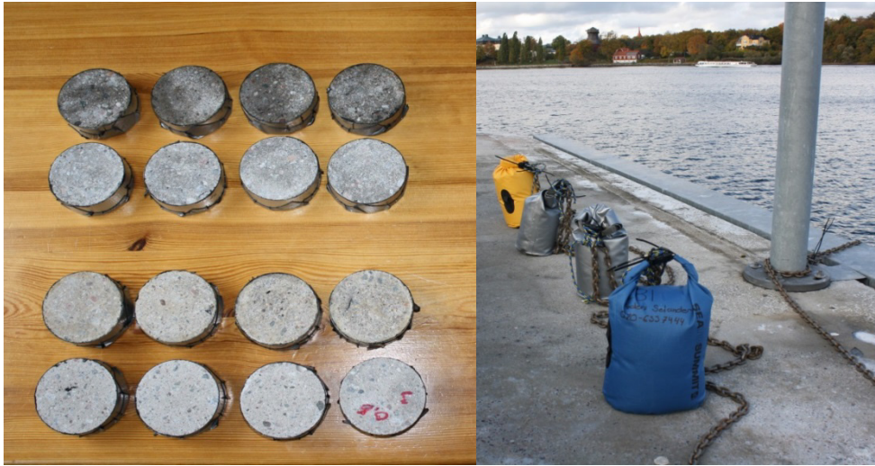
Figur 3: Foto av provkropparna (d=75mm, h=30mm) och foto av påsarna med 15 % NaCl som sänktes ned till olika djup.
