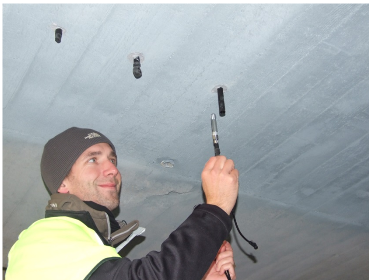
Figur 6 Inmontering av temperatur- och fuktgivare i förborrade hål, undersida brolåda, Göteborg.
