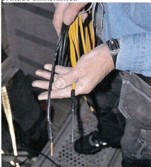
Figur 5 Utseendet hos titanelektrod (höger) och mätelektrod av kolstål (vänster)
