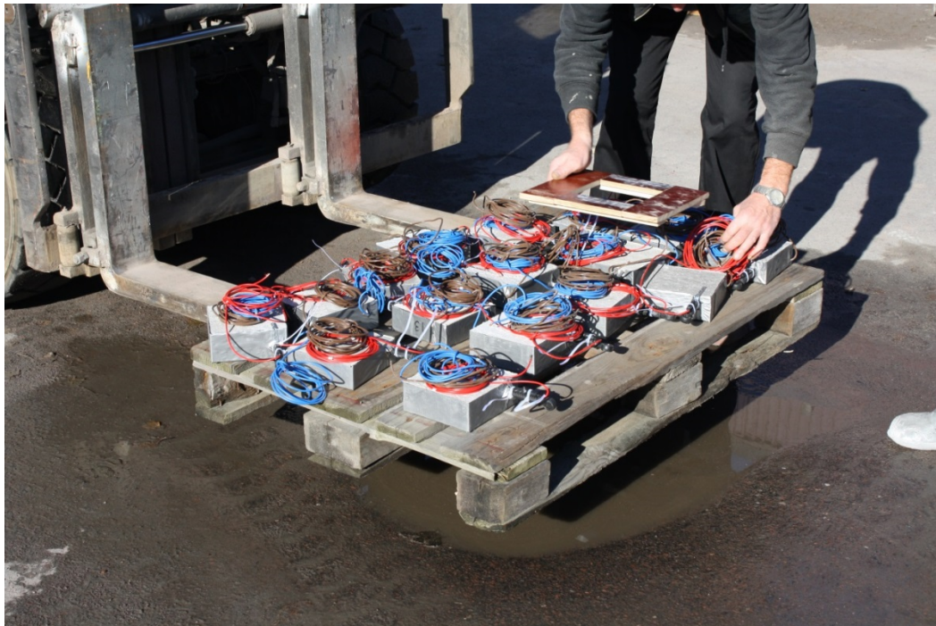
Figur 15 Provblocken innan sprutning. Den röda kabeln ansluts till zinkskiktet i samband med sprutningen.
