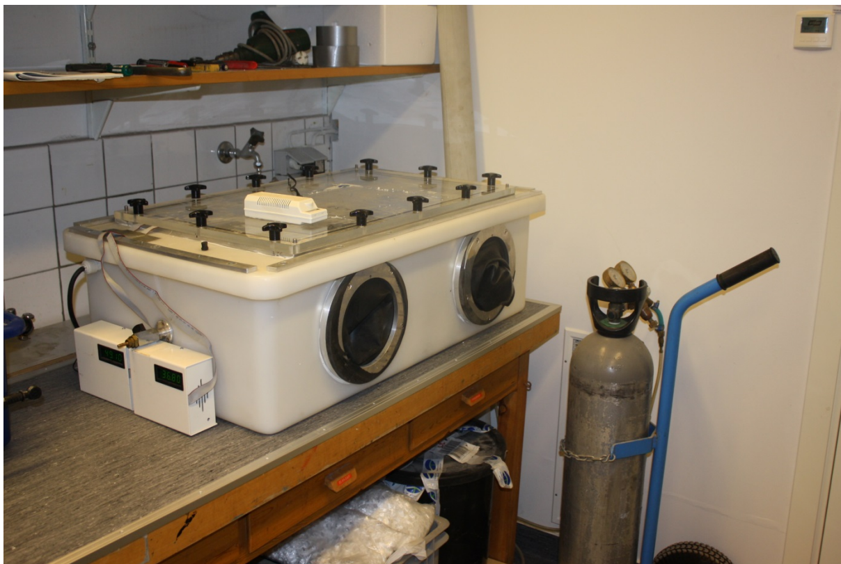
Figur 14 CBI:s CO 2 -box som användes vid karbonatiseringen av provblocken.
