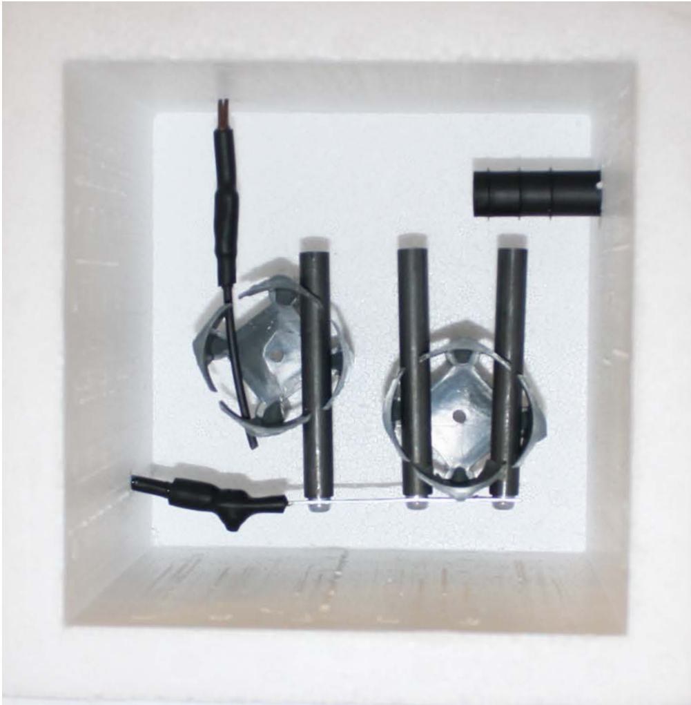
Figur 12 Foto av provblocket innan gjutning. Frigolitformar som normalt används för att gjuta 150mm kuber användes för tillverkningen.
