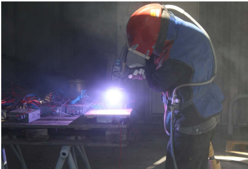
Figur 16 Ljusbågssprutning av provkropparna.
